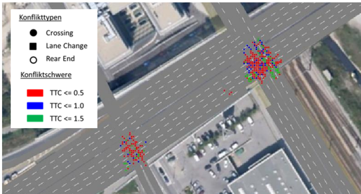
Abbildung 76: Konfliktlageplan Einfädelungsbereich der Hauptfahrbahn Richtung Hirschstetten: Crossing-Konflikte
