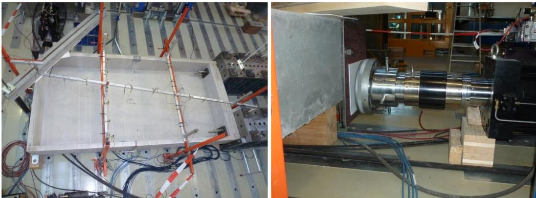
Abbildung 5.10: Versuchsanordnung für VBT 190 und Lastabgabezylinderkolben [Verfasser, LKI]
