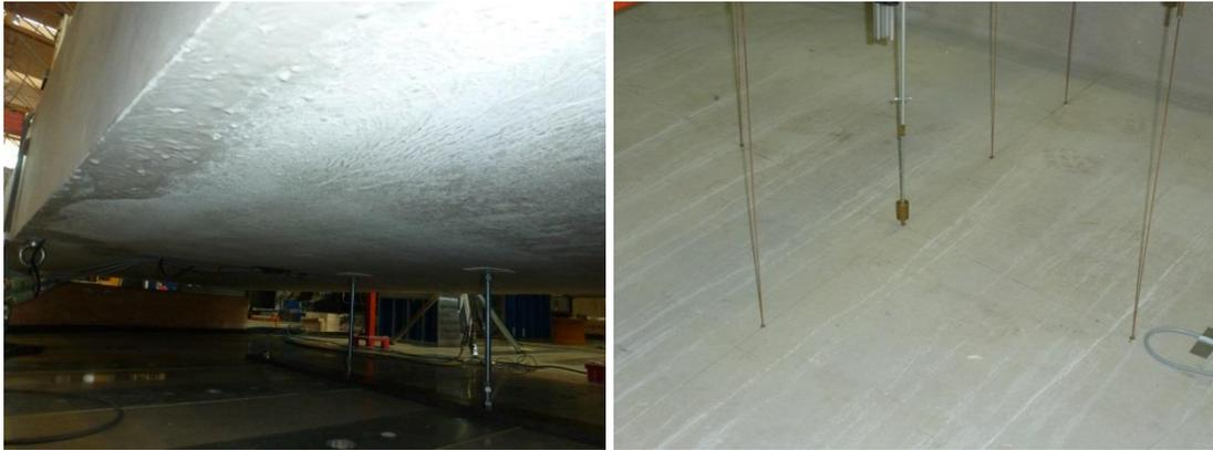
Abbildung 5.7: Beulunterstützung und Verformungssensor für Wegsteuerung [Verfasser, LKI]
