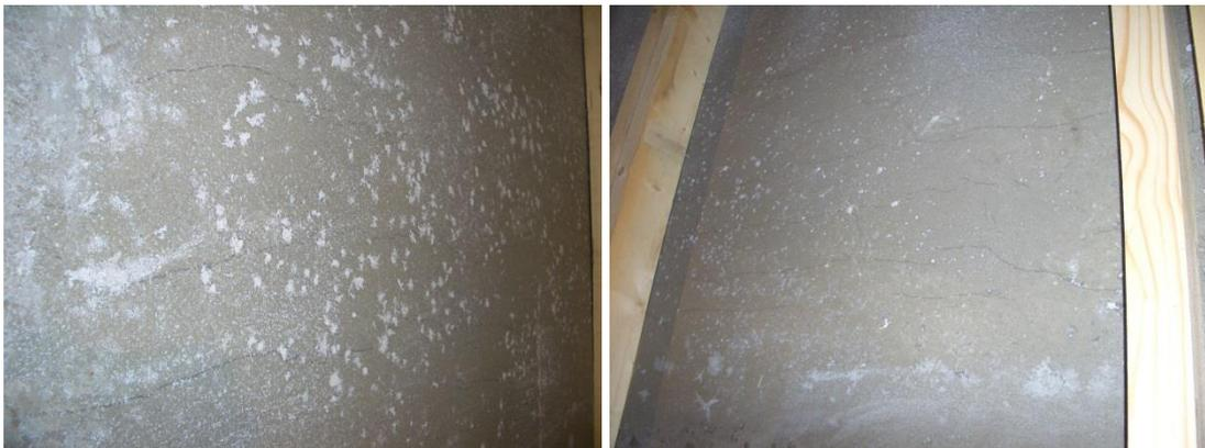
Abbildung 5.4: Schwindrisse am VBT 290-01 und VBT 290-02 [IBB, SW]
