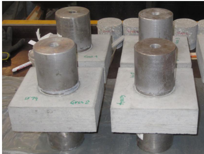
Bild 3.21 Probekörper für die Haftzugversuche an Gusseisen
