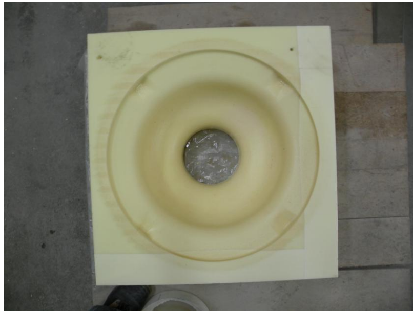
Bild 6.5 Außenschalung des Prototyps
