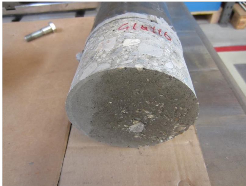
Bild 3.26 Bruchbild bei glatter UHFB-Oberfläche
