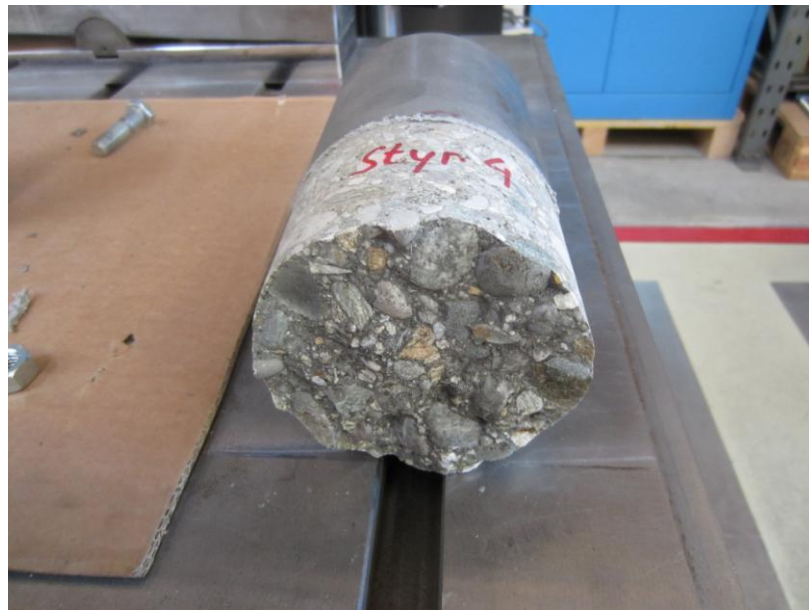
Bild 3.24 Bruchbild bei Styroduroberfläche
