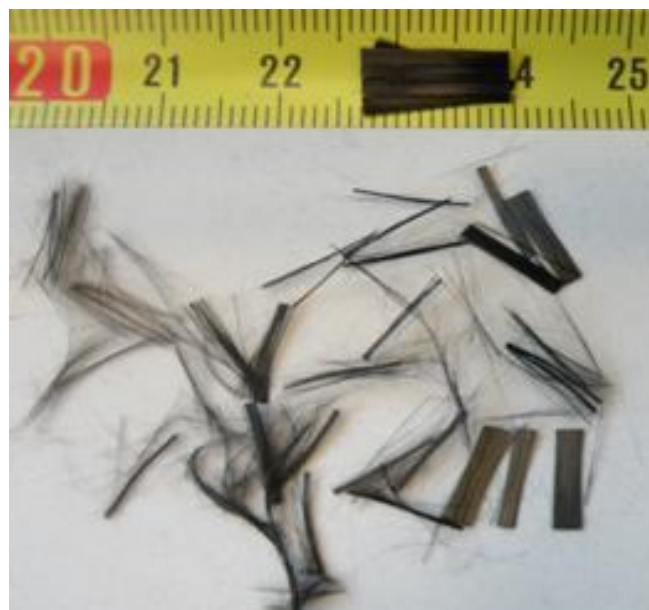
Bild 3.28 In den ersten Versuchen verwendete Fasern ( 7\ \mu\text{m} Durchmesser), Bild 1 in [63 S. 1]
