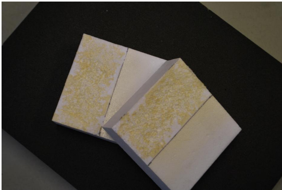
Bild A8.1 Tesa® Sprühkleber auf EPS
