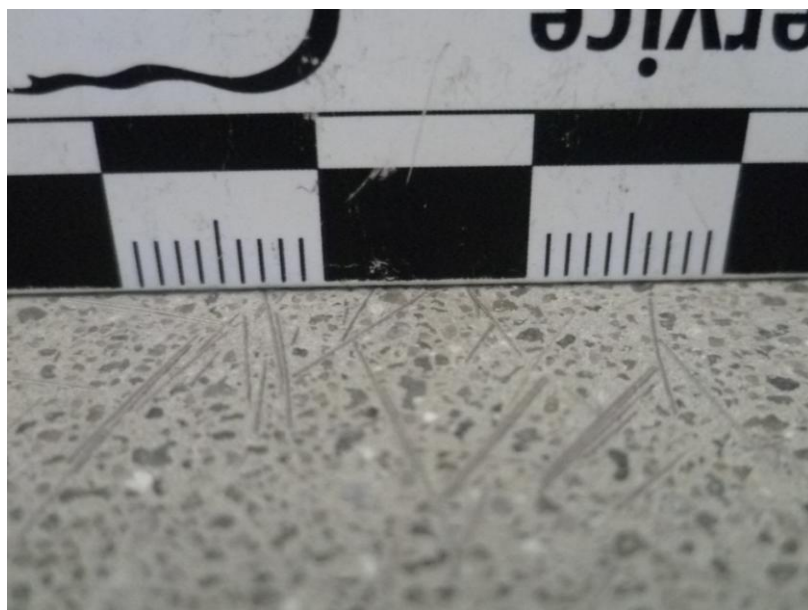
Bild 3.15 Nach einem Tag 1x sandgestrahlte UHFV-Oberfläche
