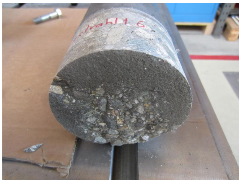
Bild 3.25 Bruchbild bei sandgestrahlter UHFB-Oberfläche
