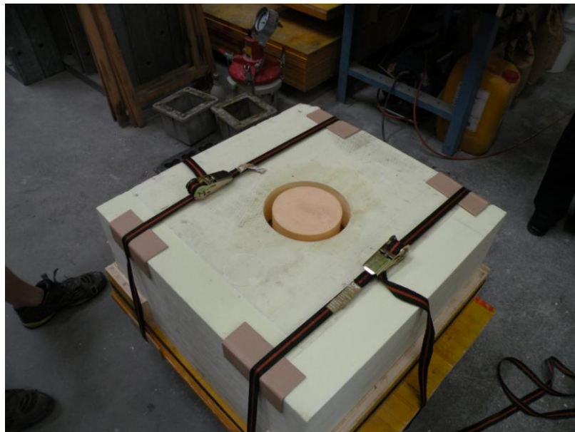
Bild 6.6 Zusammengesetzte Schalung am Rütteltisch
