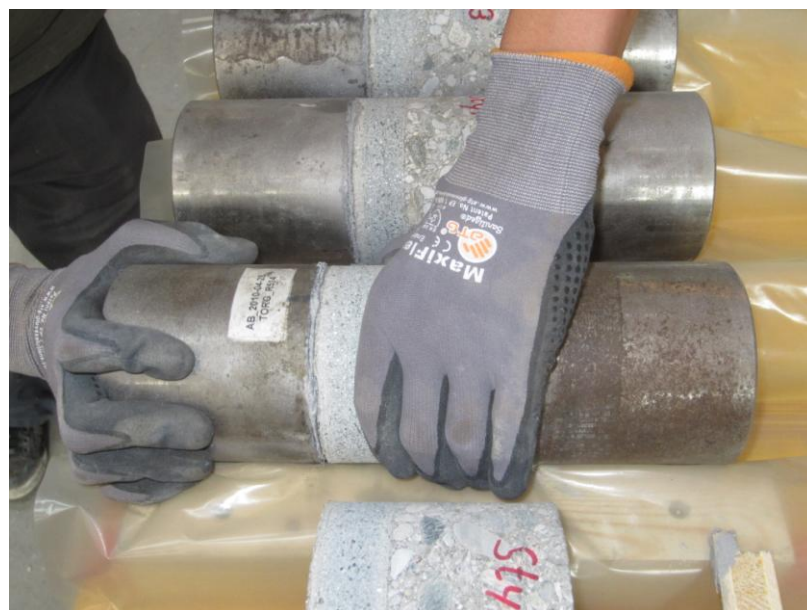
Bild 3.20 Vorbereitung der Prüfkörper durch Aufkleben der Stahlstempel
