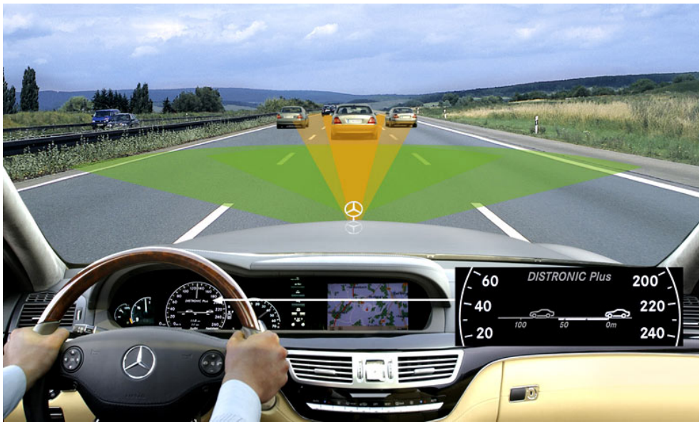
Abbildung 2.1: Illustration eines DISTRONIC-Systems, Quelle: Mercedes-Benz, [2]
