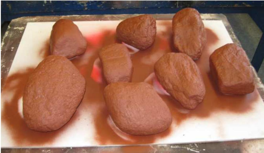
*Abbildung 19: Grundierung der Tracer (Lämmerer, 2013)*
