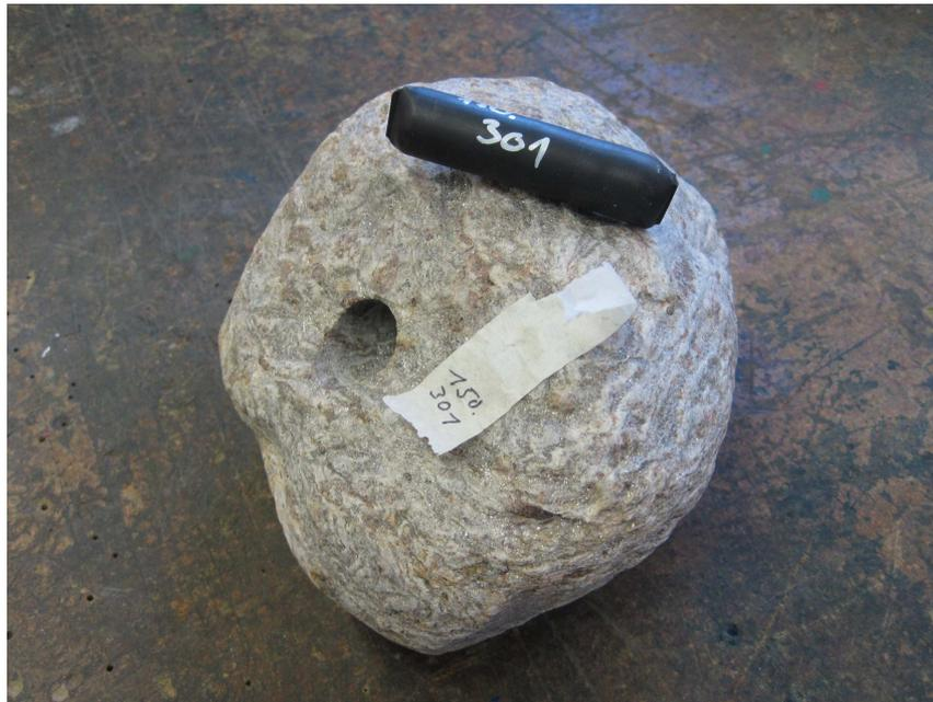
Abbildung 20: Telemetrietracer mit Sender
