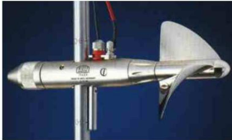
Abbildung 24: Flügelmessung (Knoblauch&Schneider, 2009)
