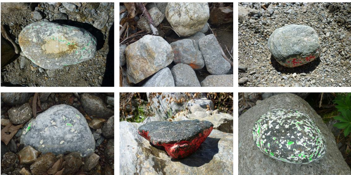
Abbildung 73: Abrieb der Tracer im Einzugsgebiet
