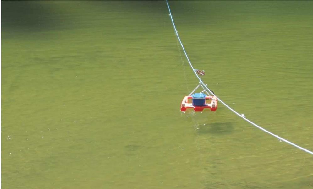
Abbildung 25: ADCP Messung am Schöttlbach in Oberwölz
