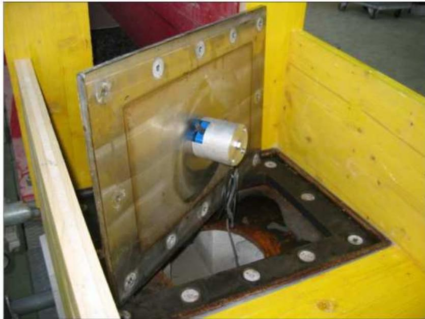
Abbildung 15: Unter einer Stahlplatte montierter Geophonsensor (Turowski, 2011)
