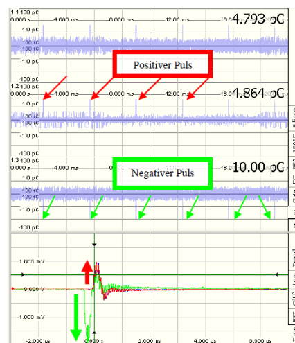
Abbildung 49 Unterscheidung zwischen Teilentladung und Störer aufgrund der Polarität [RET09]
