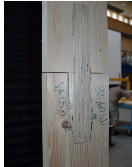
b) Holzbruch an lokaler Fehlstelle (Ast)
