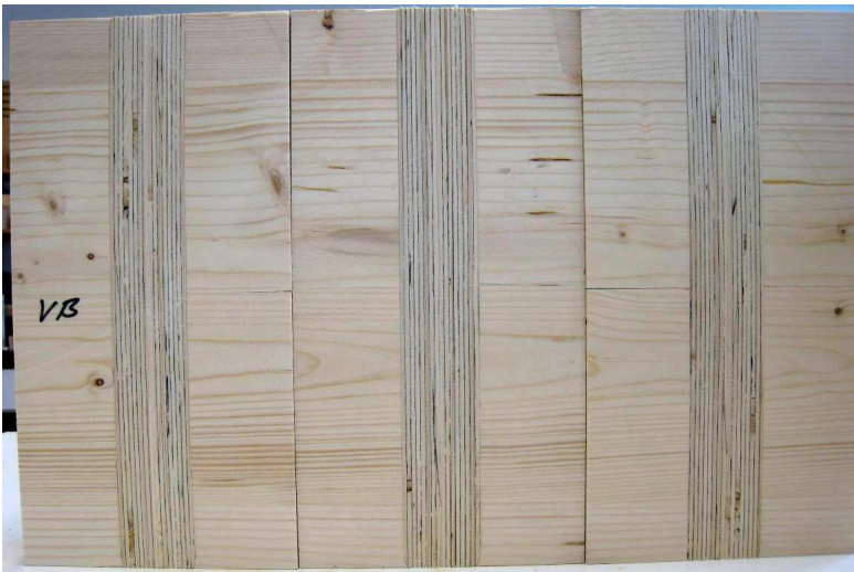
Abbildung 5: Bauteile „VB“ vor der Delaminierungsprüfung
