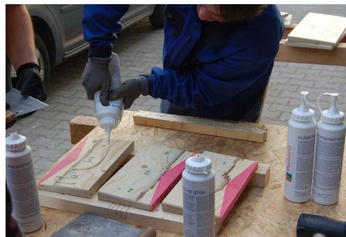
auftragen des 1K-PU-Klebstoffs (Purbond HB-S709)
