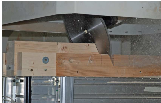
Abb. 7.5 Abbund der Rüstung auf der CNC-Anlage, die fertige Rüstung. (Quelle: IAM-TU-Graz)
