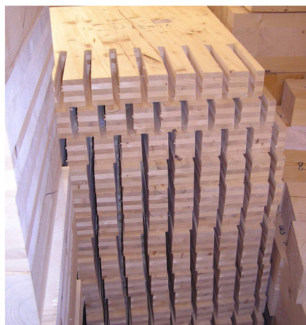
Abb. 5.52 Lagerung der BSP-Platten in der Klimakammer
