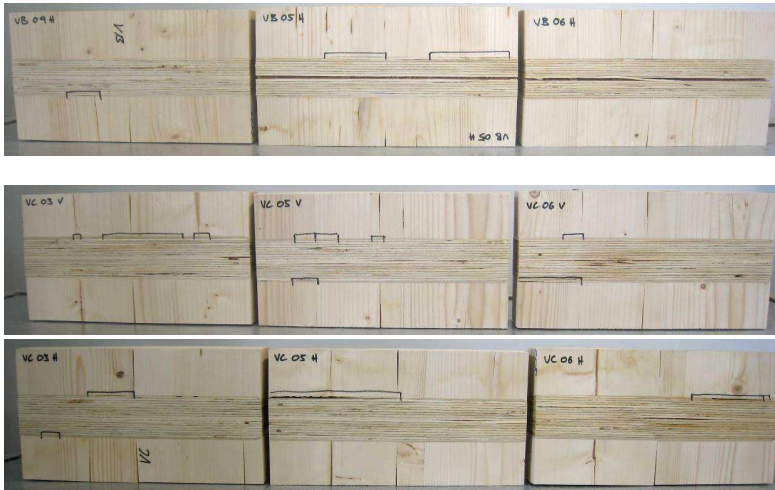
Abbildungen 7-12: Bauteile nach der Delaminierungsprüfung – Aufgerissene Kerto Platte, Markierte Delaminierung (nicht gewertet). „V“ = vorne, „H“ = Hinten.
