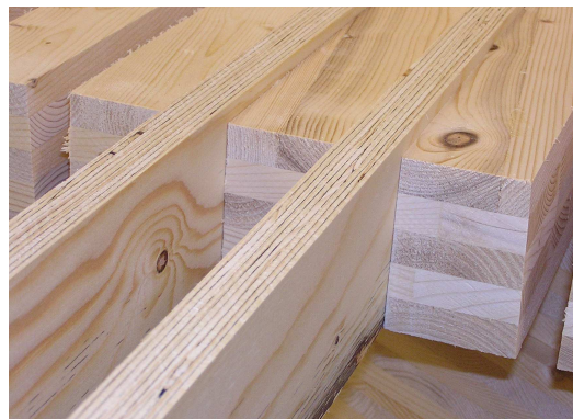
Abb. 5.54 Prüfen der Passgenauigkeit vor dem Verkleben (Verklebevariante A)
