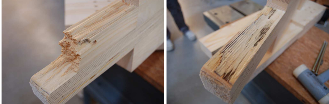
Abb. 5.31 Bruchflächen des Prüfkörpers VB-u-03
