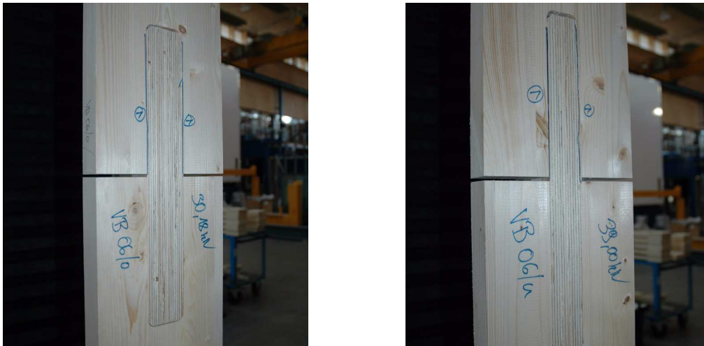
Abb. 5.29 Vorwiegende Bruchursache Schubversagen im Bereich der Klebefuge (meistens Holzbruch)
