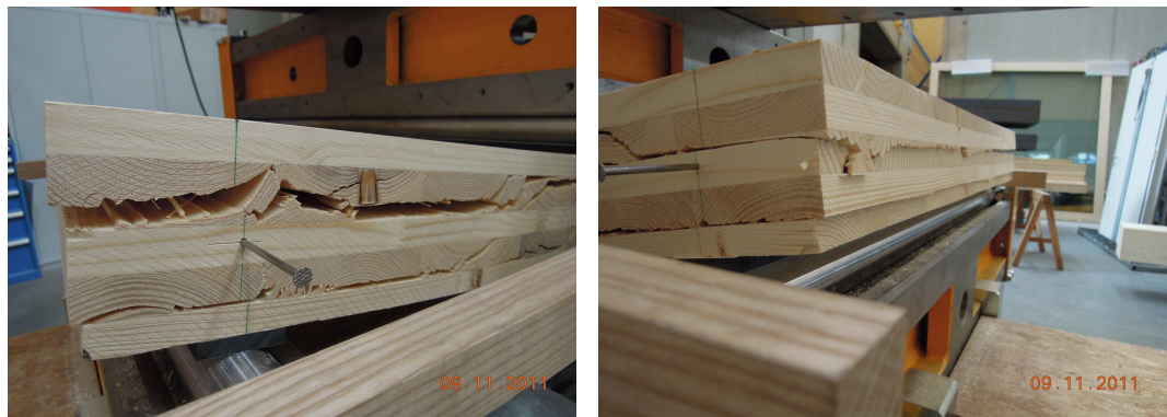
Abb. 5.111 Rollschubbruch im Auflagerbereich
