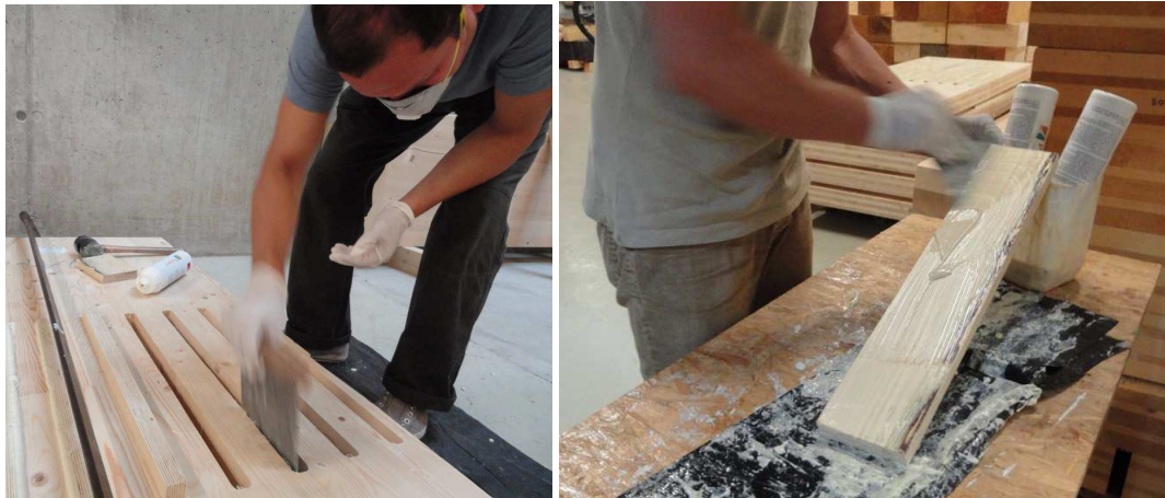
Abb. 5.55 Beileimen von Schlitz und Verbinder der Biegeprüfplatten mit der Zahnschachtel
