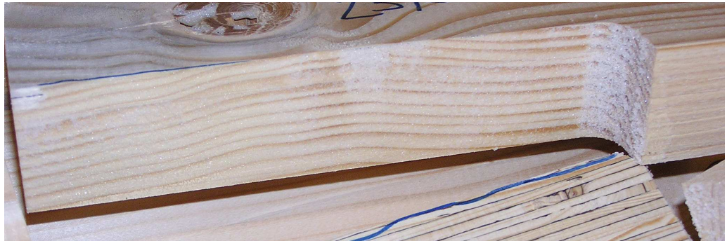
Abb. 5.34 Vorwiegend Kleberversagen- Beurteilung als Klebstoffversagen
