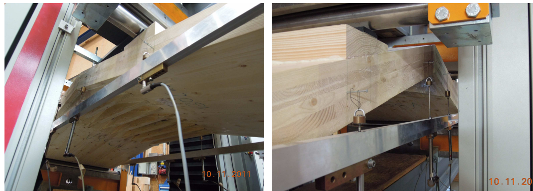
Abb. 5.68 Bilder Biegeprüfung Konfiguration V30-0-A-n-u-800; Untersicht, Wegaufnehmer
