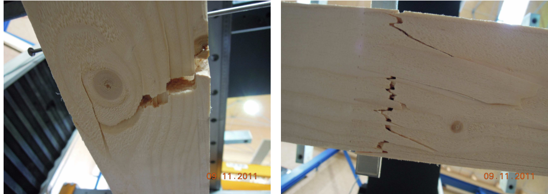
Abb. 5.110 Biegebrüche an lokalen Fehlstellen: Kernast; Biegebruch im Bereich der Keilzinkung
