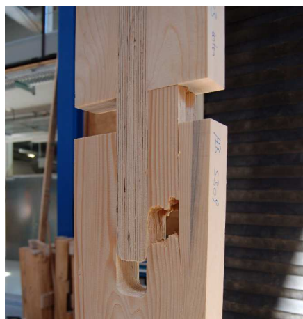
Abb. 5.30 Mischbruch des Prüfkörpers VB-u-03 (Zug- und Schubversagen)
