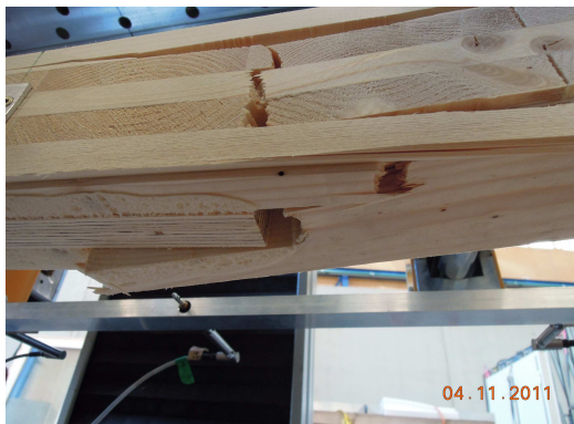
Abb. 5.76 Biegebruch BSP-Platte im Nettoquerschnitt
