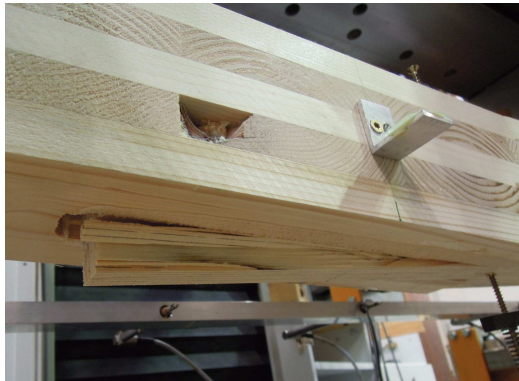
Abb. 5.75 Schubbruch der Kertverbinder
