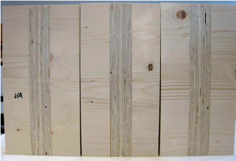
Abbildung 4: Bauteile „VA“ vor der Delaminierungsprüfung
