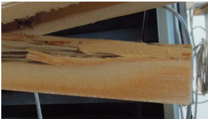
Abb. 5.74 Wenig Holzfaserbelag bei Querkzugversagen des Kertverbinders
