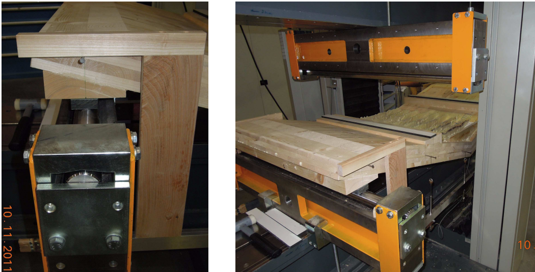
Abb. 5.65 Bilder Biegeprüfung Konfiguration V30-0-A-p-u-800; Auflager und Lasteinleitung
