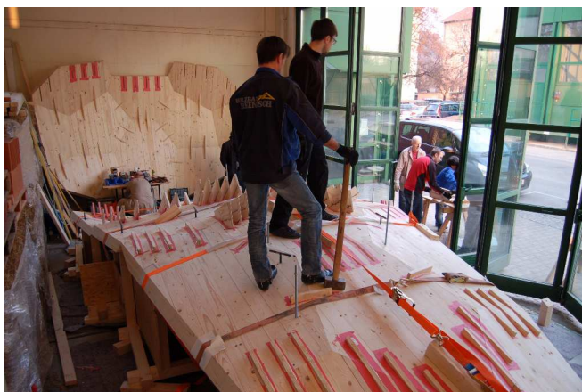
Abb. 7.8 Die Verklebung des Basisteils (Quelle: IAM-TU-Graz).
