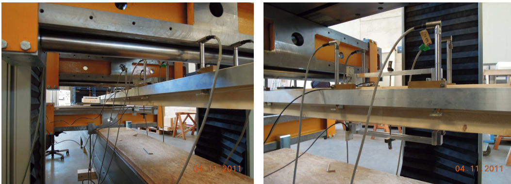
Abb. 5.62 Biegeprüfung Konfiguration V0^\circ mit Breite 85 mm; Messlatte mit Wegaufnehmern und Dehnungsmessern
