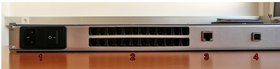
Abbildung 5.7: Hinterseite des XC-1124A mit Ein- und Ausgängen
