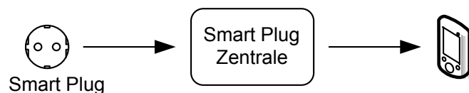
Abbildung 4: Informationsweg Smart Plug über Smart Plug Zentrale zu Mobiltelefon
