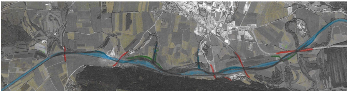
Abb. II-28: Ausschnitt aus einem Luftbild orthoentzerrt aus dem digitalen Atlas Steiermark – abgebildet ist der Lauf der Enns südlich von Liezen mit einer eingezeichneten gleichmäßig an- und abschwellenden Kurvenbahn und einer Kennzeichnung der vorhandenen Infrastrukturanlagen und Zubringerbachmündungen (Abbildung der Originalskizze siehe Anhang Abb. IV-10)
