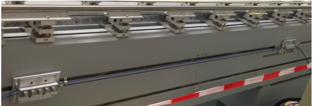
Abb. 5.11: Vorgespanntes Sensorkabel BRUsens Strain V4
