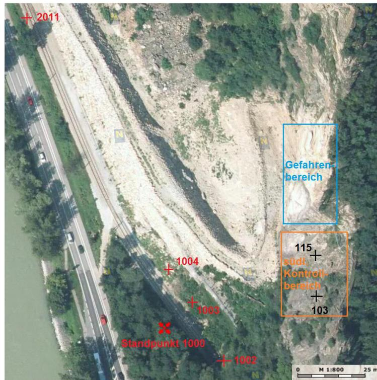
Abbildung 2-9: Ausgewählte Kontrollpunkte zur Bestimmung der Korrekturparametern am Standpunkt 1000
