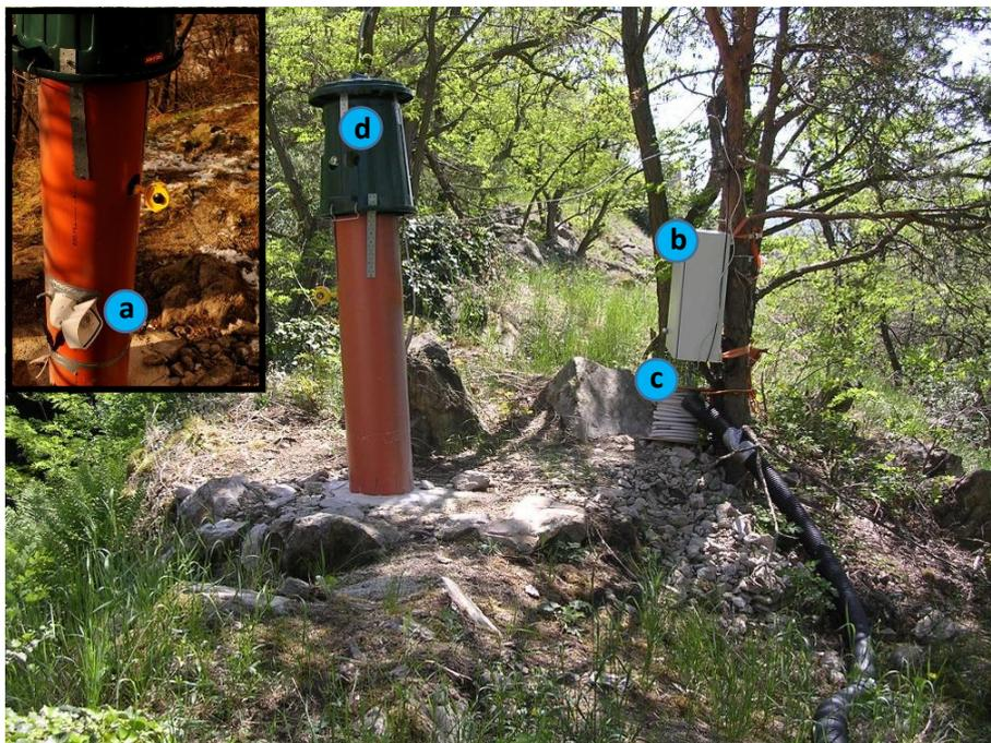
Abbildung 2-1: südlicher Pfeiler 1000 (Totalstation befindet sich unter dem Witterungsschutz (d)) mit WebCam (a), Recheneinheit (b) und Meteorologie -Sensor (c) [AVT (2012)]
