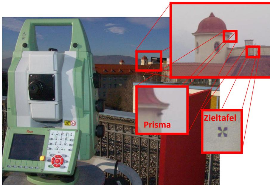
Abbildung 6-1: Beobachtete Punkte der Messungen Prüffeld "Dach Steyrergasse 30"
