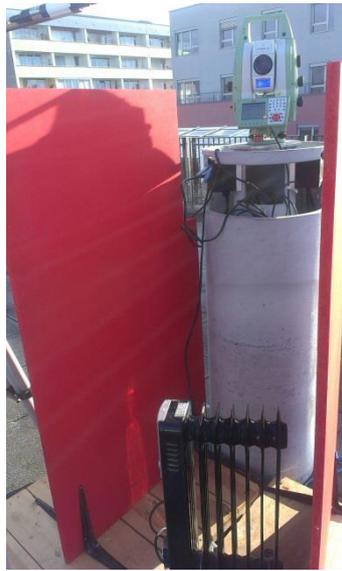
Abbildung 5-5: Testsetup Prüffeld "Dach Steyrergasse 30": Radiator
