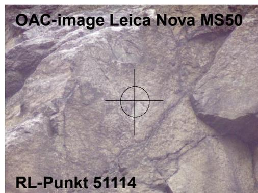
Abbildung 4-18: Koaxiales Foto des reflektorlosen Punktes 51114
