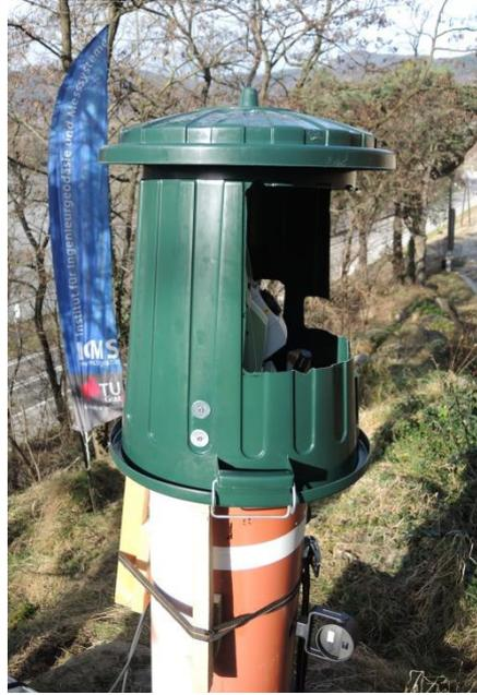
Abbildung 5-9: Leica Nova MS50 am Pfeiler 1000 mit nachgebaute Witterungsschutz
