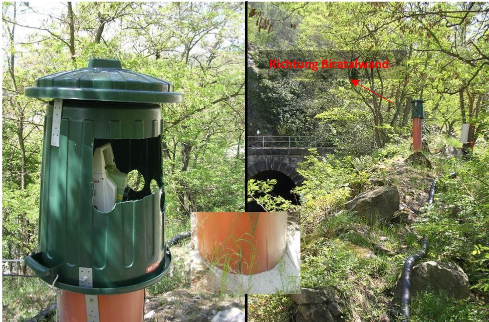
Abbildung 2-4: südlicher Pfeiler mit Witterungsschutz und geschlitzter Schutzverkleidung Standpunkt: 1000 [AVT (2012)]
