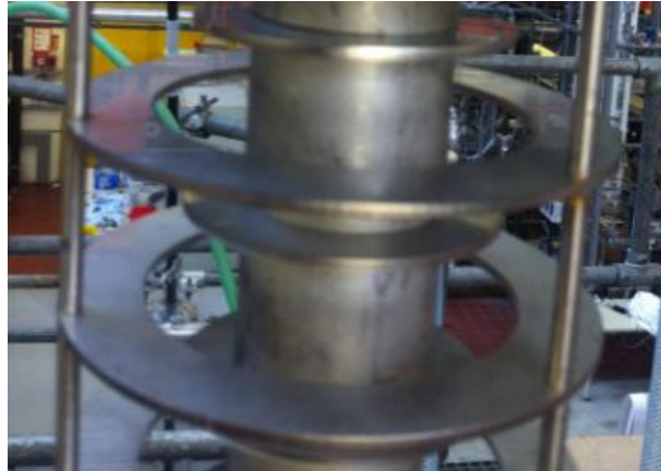
Abbildung 3-6: Statorhülsen als Abstandhalter für Statorscheiben
