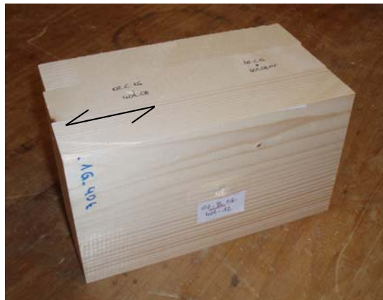
Abb. 4.18 „Vollholz“-Prüfkörper der Serie C_40t
