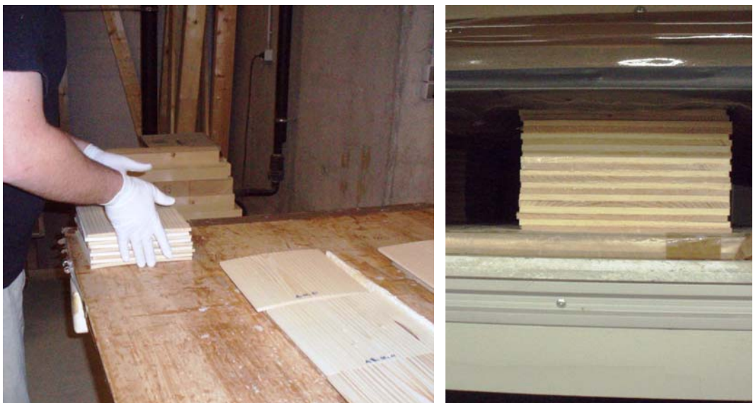
Abb. 4.13 Fertigen der Prüfkörper – Ausrichten und Übereinanderstapeln der Einzellamellen (links) und Pressen eines Brettspertholzprüfkörpers (rechts)
