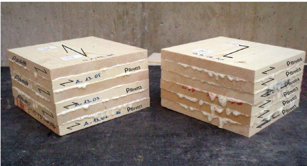
Abb. 4.14 Aufbau der BSP- und BSH-Prüfkörper am Beispiel der Gruppe 20t
