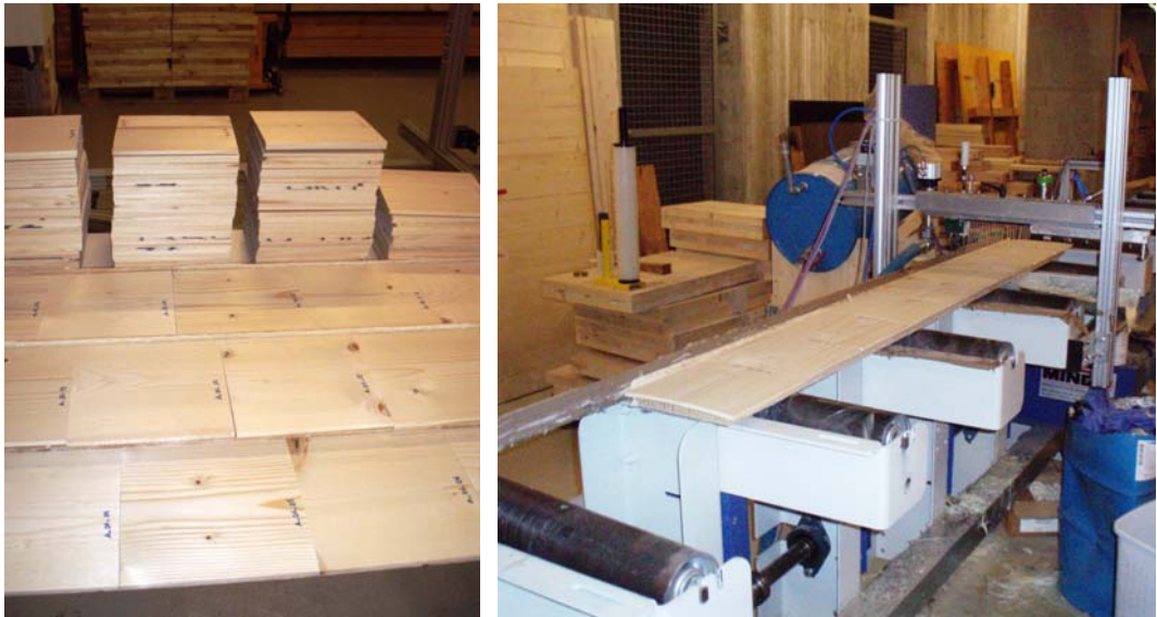
Abb. 4.12 Fertigen der Prüfkörper – Vorbereiten der Einzellamellen für den Klebstoffauftrag (links) und automatisches Auftragen des Klebstoffes durch die Klebstoffauftragsmaschine (rechts)
