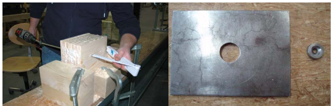
Abb. 4.21 Eindrehen der Schrauben (links) und die Bauteile Lagerplatte und Einhängering (rechts)
