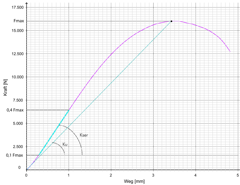
Abb. 4.22 Darstellung der Bereiche zur Ermittlung der Verschiebungsmoduln K_{ser} und K_u am Beispiel einer tatsächlich aufgezeichneten Last-Verschiebungskurve
