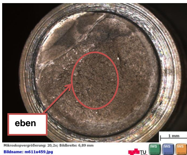
Abbildung 5.4: Bruchfläche der Probe 2011_02_CrMoV4-6_400_5 nach 0,1 Stunden bei 3678 MPa Biegespannung.
