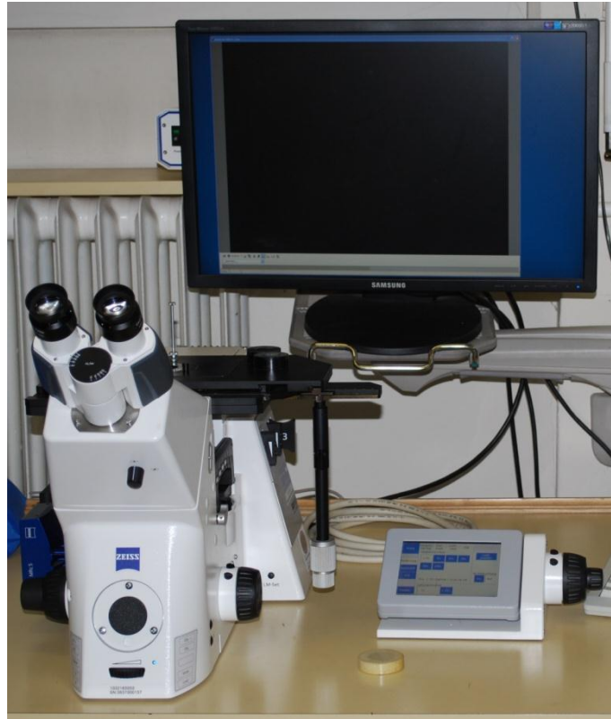
Abbildung 4.13: Lichtmikroskop Observer Z1m.
