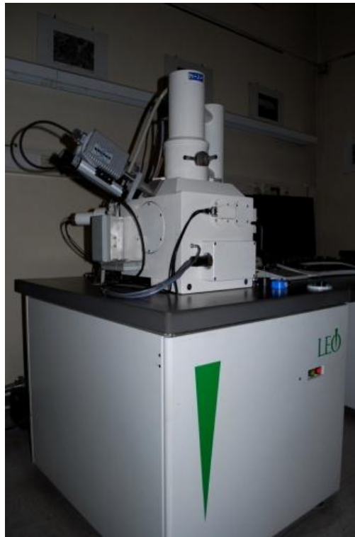
Abbildung 4.15: Rasterelektronenmikroskop 1450VP der Firma Zeiss.
