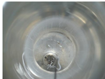
Abbildung 2.12: Proben im Inneren des Dewargefäßes.
