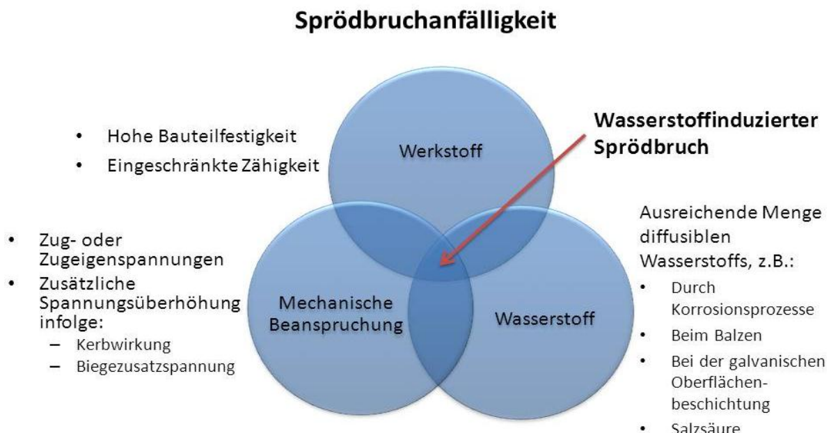
Abbildung 2.1: Sprödbriechanfälligkeit und Sprödbriechgefährdung hochfester Bauteile. (6)
