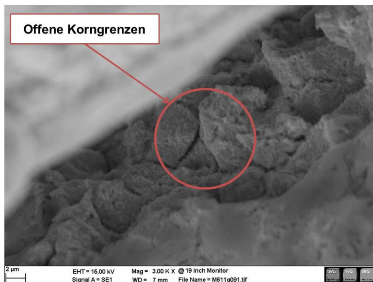
Abbildung 5.32: Position 2 der Probe 2011_05_40CrMoV4-6_600_2b_SE 3000x.
