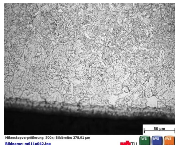
Abbildung 4.8: Randbereich des Probenmaterials; 40CrMoV4-6 martensitisches Gefüge bei 600 °C angelassen.
