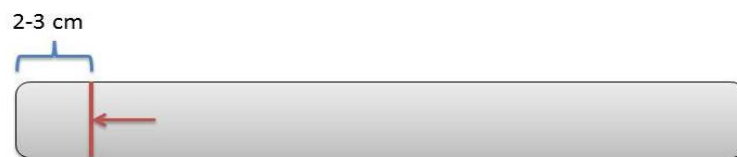
Abbildung 4.3: Probenahme am wärmebehandelten Draht.
