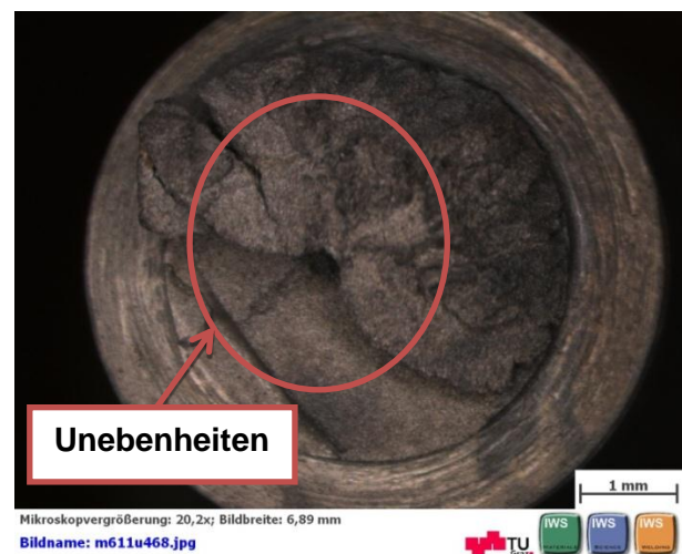
Abbildung 5.5: Bruchfläche der Probe 2011_02_CrMoV4-6_400_11 nach 5,12 Stunden bei 1773 MPa Biegespannung.
