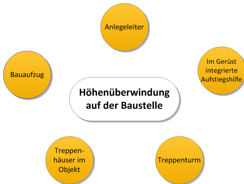
Abbildung 1: Arbeitsmittel zur Höhenüberwindung auf Hochbaubaustellen
