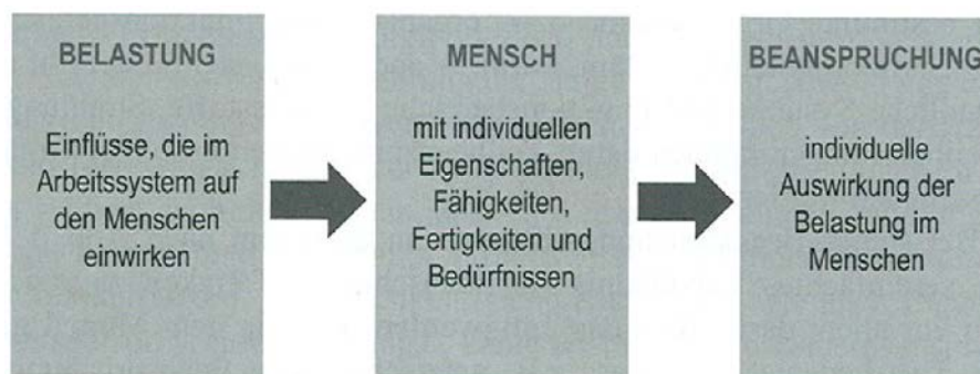
Abbildung 28: Das einfache Belastungs- Beanspruchungs-Konzept (ROHMERT 1983) 101
