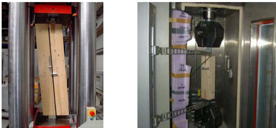
Abb. 2.31 Druckscherversuch und Zugversuch in Klimaschrank [19]
