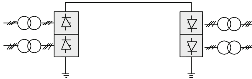
Abbildung 3: Monopolare Ausführung mit Erdrückleiter [9]
