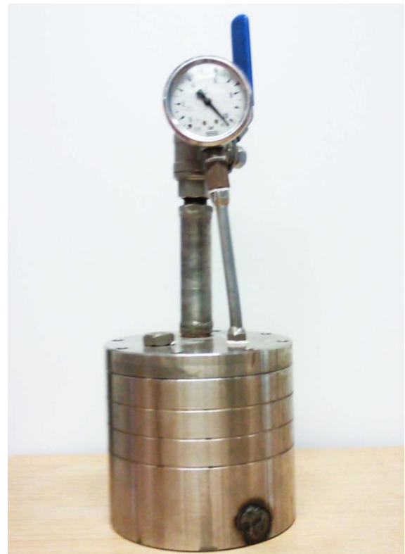
Abbildung 26: Experimentalreaktor aus Stahl
