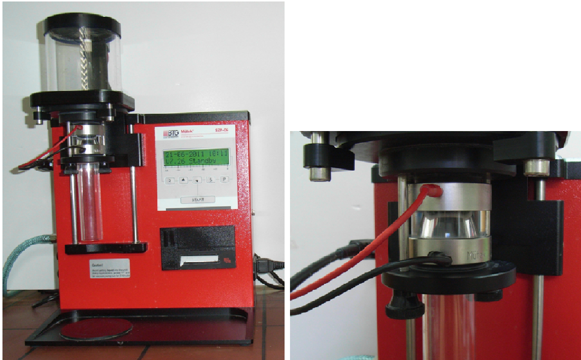
Abbildung 16: Müttek SZP (links) und Detailaufnahme Elektroden (rechts)
