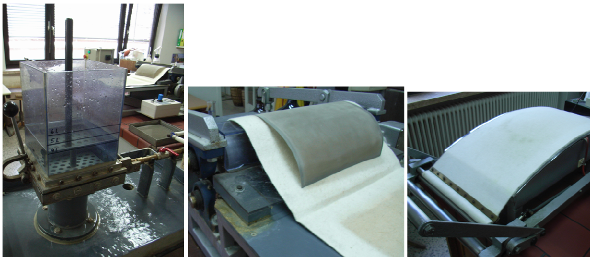
Abbildung 18: Laborblattbildung: Blattbildner – Presse mit Doppelfilz – Trockenzylinder
