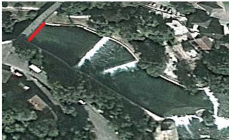
Abbildung 21: Messprofil vom Wasserfall flussaufwärts, unterhalb der Fussgängerbrücke
