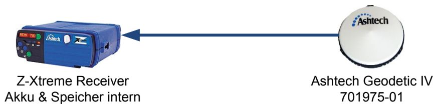
Abbildung 5.3: Die dargestellten Komponenten waren an jeder der beiden Referenzstationen im Einsatz.
