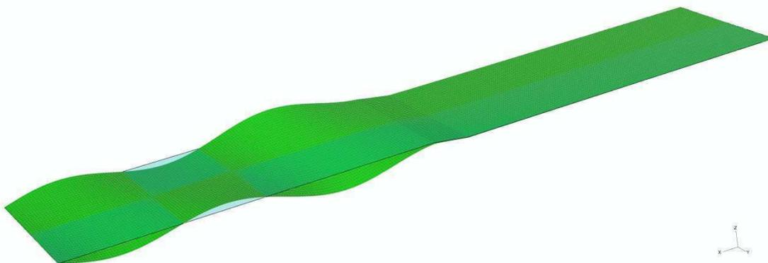
Abbildung 283: Platte OB  $B=600$ ,  $\alpha=10$ ,  $t1/t2=3.00$ , 3.Eigenform,  $EV3=2.2311$ ,  $k_{\sigma}=0.903$ ,  $\sigma_{crit,ABQ}=761.66 \text{ N/mm}^2$
