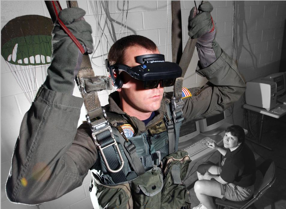
Fallschirmspringer der US-Navy üben mit Head-Mounted Displays virtuell das Fallschirmspringen
