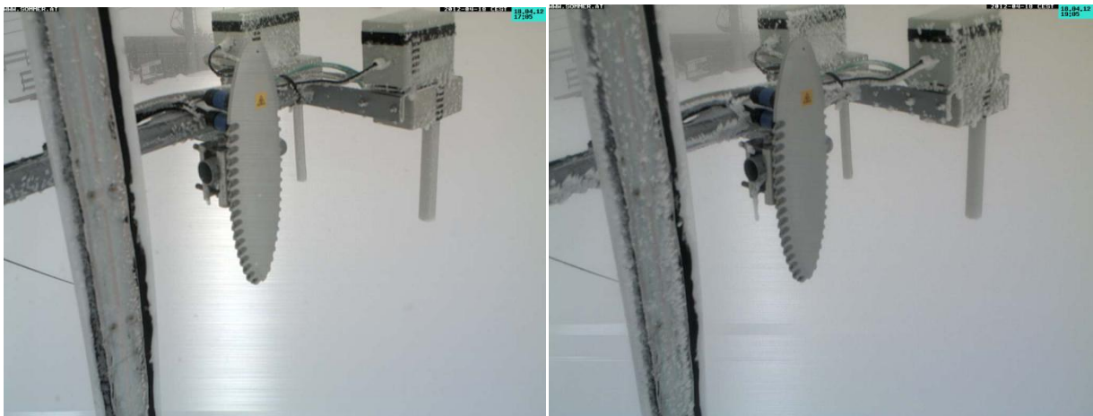
Abbildung 92: Vereisungsereignis 3, 18. 04. 2012, 17:00 Uhr (links), 19:00 Uhr (rechts)
