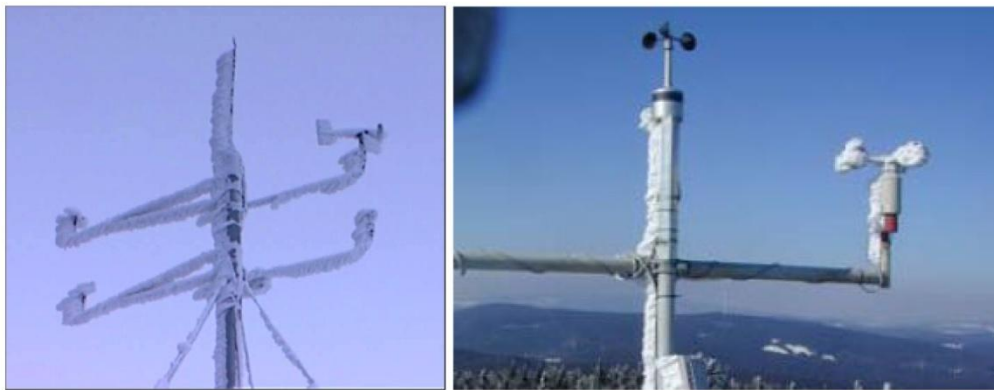
Abbildung 10: Links: Vereiste unbeheizte Messgeräte (Matzendörfer Stierenberg, Schweiz). Rechts: Beheiztes und unbeheiztes Anemometer (Sternstein, Österreich), (Cattin, 2008)
