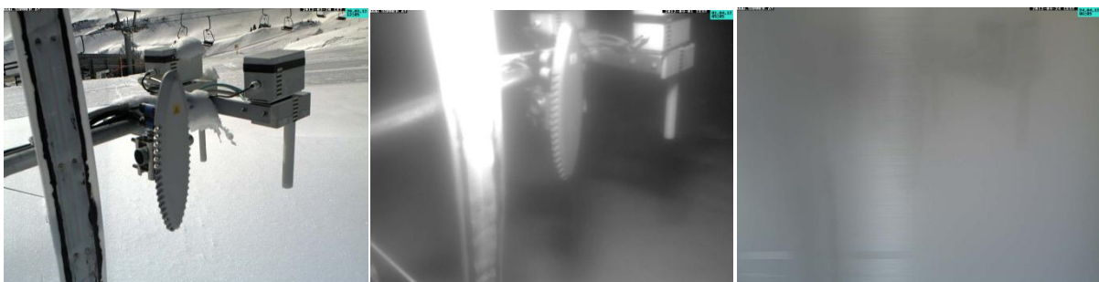
Abbildung 40: Beispiele der einzelnen Zuverlässigkeitsklassen für die Bildauswertung (von links nach rechts): Klasse 1: 20.03. 12 Uhr; Klasse 2: 01.04. 05 Uhr; Klasse 3: 01.05. 05 Uhr
