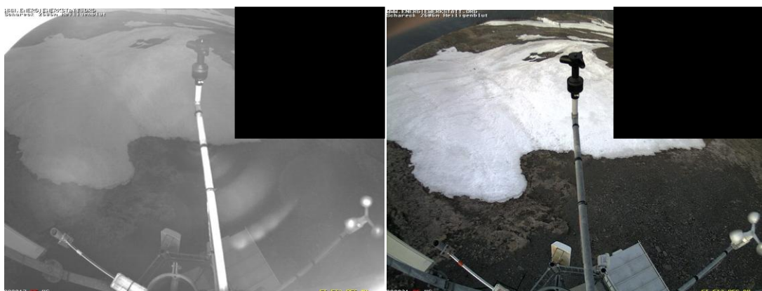
Abbildung 64: Aufnahmen des 05.05.2011 um 05:02 Uhr (links) und 05:22 Uhr (rechts): Während die starke Reflexion am mittleren Ausleger des linken Bildes ein Indiz für Vereisung ist, kann aufgrund des geänderten Aufnahmemodus rechts kein Eis festgestellt werden.
