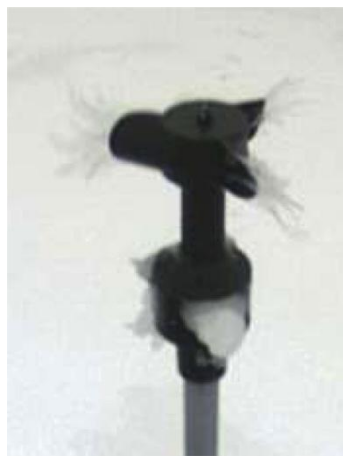
Abbildung 12: "Zäpfchenbildung" und somit Verfälschung der Messung eines beheizten Anemometers, (Lachinger, 2011)
