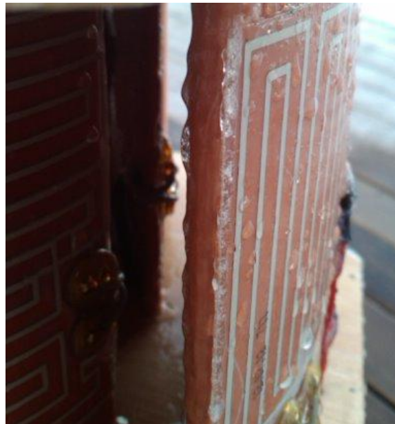
Abbildung 83: Vereisung an den Kanten der Kreissegmente
