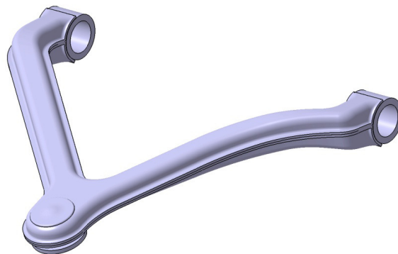
Abbildung 8.21 - Oberer Querlenker aus 2 Blechschalen
