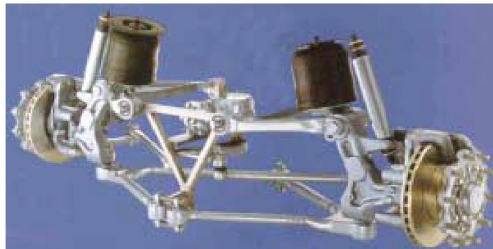
Abbildung 3.29 – ZF Einzelradaufhängung der Vorderräder [17]
