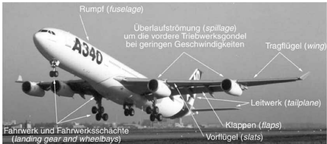
Abbildung 1.1: Lärmquellen an einem anfliegenden Verkehrsflugzeug [14]
