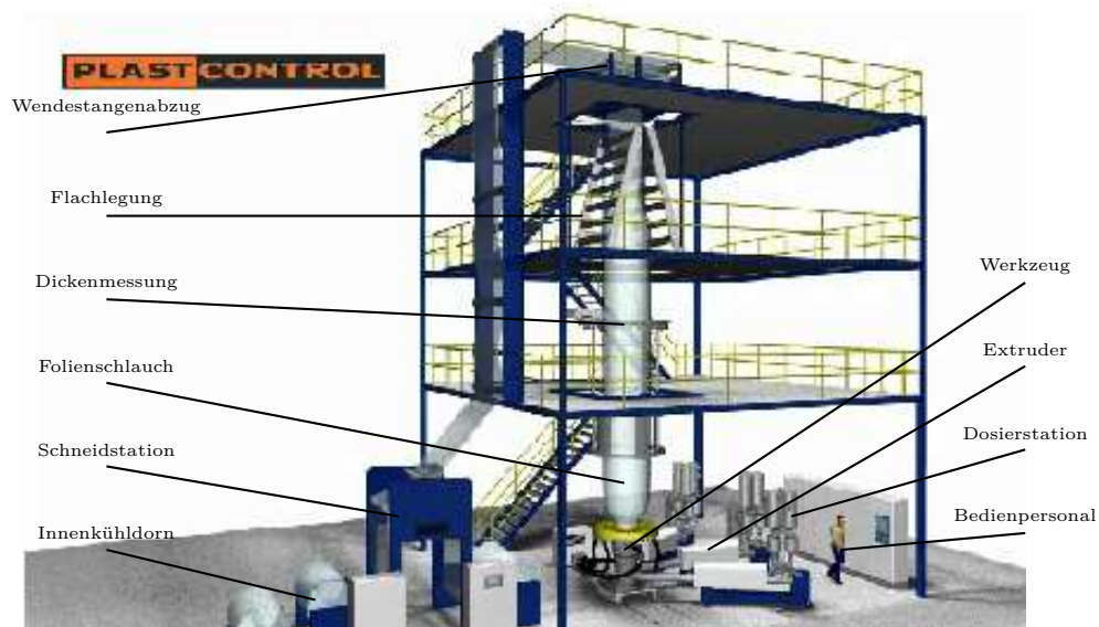
Abbildung 3.5: 3D Ansicht einer Blasfolienextrusionsanlage [Pla11]
