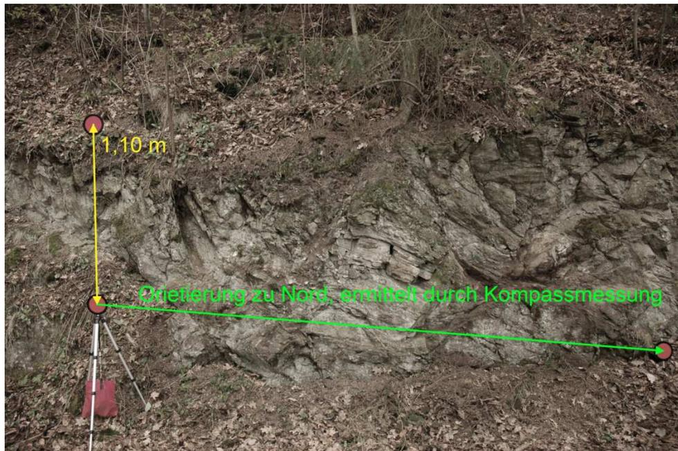
Abbildung 14: Mögliche Positionierung der Kalibrierungspunkte auf einem der beiden Bilder des Stereobildpaares. Das Stativ muss senkrecht stehen, die Mittelpunkte der roten Scheiben haben einen exakt definierten Abstand zueinander (gelb). Von einer Position aus, welche sich aus dieser Sicht links neben dem Stativ befindet, wird die grün eingezeichnete Orientierung gemessen.
