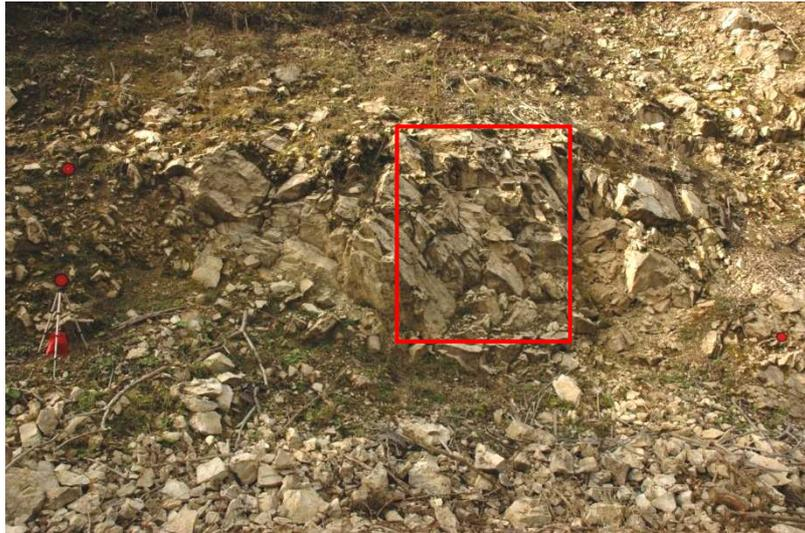
Abbildung 21: Der Bereich innerhalb des roten Rahmens wurde für klassisch von Hand mittels Scanline- Verfahren ausgewertet.
