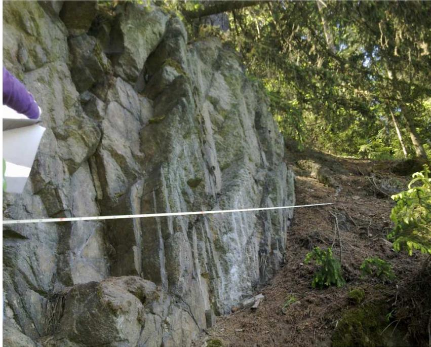
Abbildung 18: Aufschluss "G 4". Das Bild zeigt den Verlauf der Scanline.
