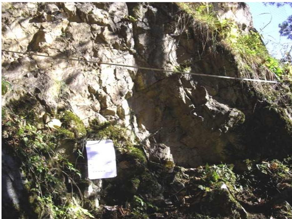
Abbildung 20: Aufschluss "DM Bundesstraße". Das Bild zeigt den Verlauf der Scanline.
