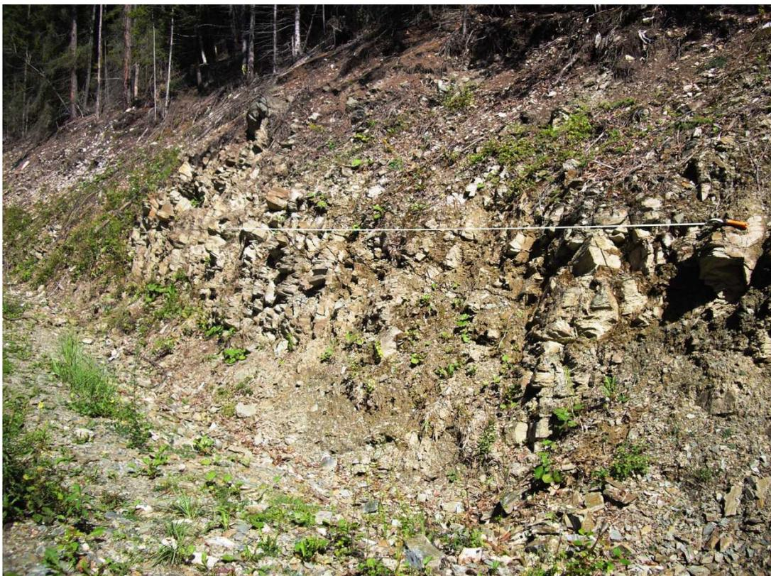
Abbildung 24: Aufschluss "GSF Ost". Das Bild zeigt den Verlauf der Scanline.
