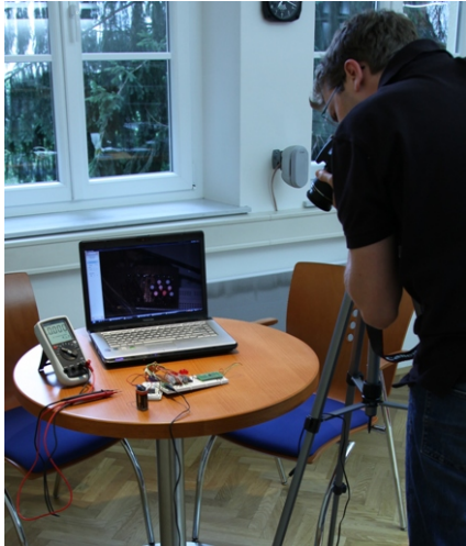
(a) Messaufbau für die Messung der Auslöseverzögerung und der Triggerimpulsbreite.
