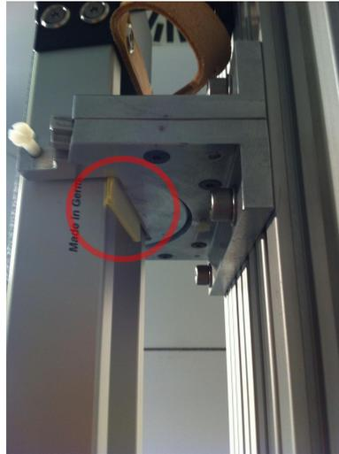
Abbildung 6.15: Verkipfung der Latte durch eingeklemmtes PostIt
