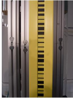
**Abbildung 2.2:** Beispiel eines Lattencodes anhand der Codefolge von Sokkia
