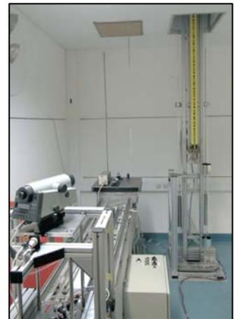
Für die Untersuchungen steht das Labor des Instituts, insbesondere der Vertikalkomparator zur Systemkalibrierung von Digitalnivellieren zur Verfügung.
