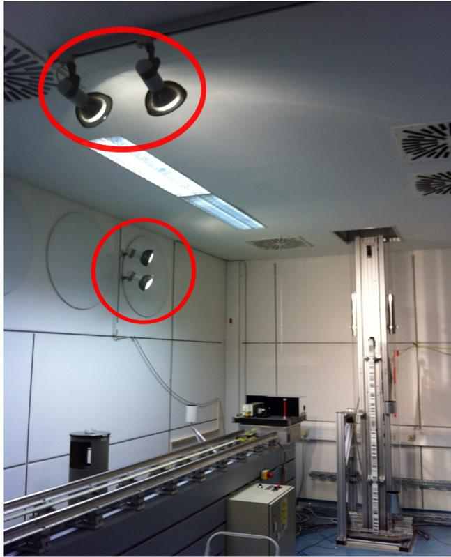
Abbildung 5.3: Zusatzbeleuchtung für Latte bestehend aus PAR38-Lampen
