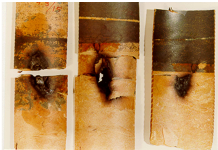
Abbildung 2-26: Teildurchschläge zwischen Potenzialsteuerbelägen [25]
