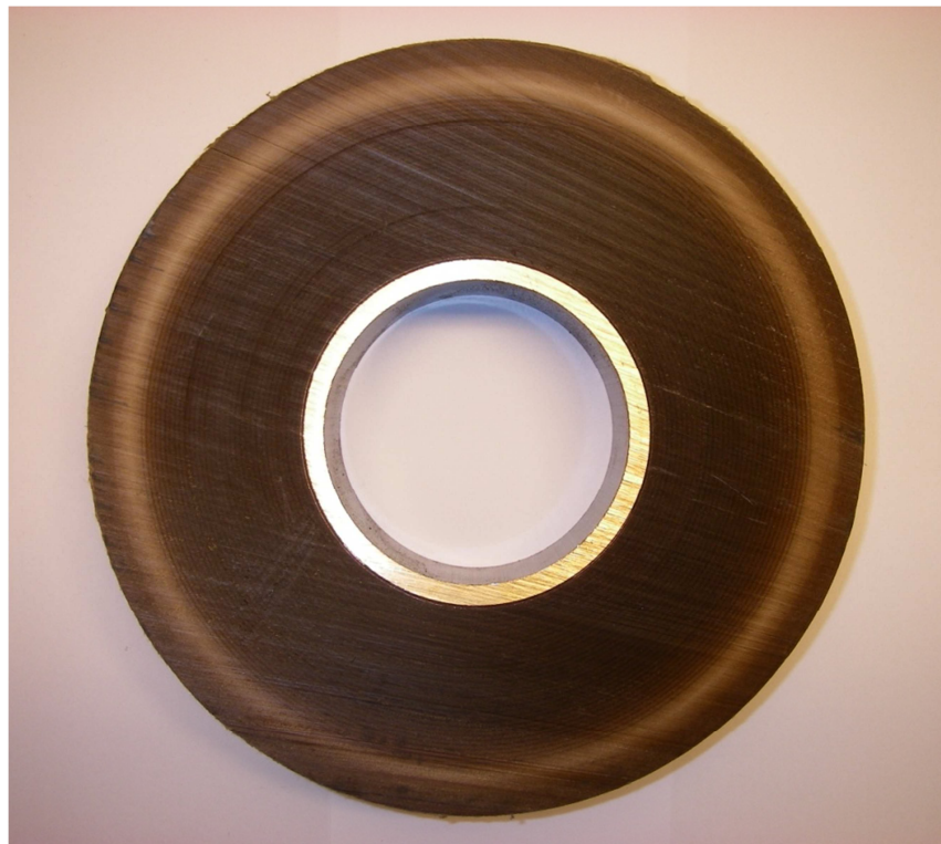
Abbildung 8-22: Schnitt der zerlegten RBP Durchführung [eigenes Foto]
