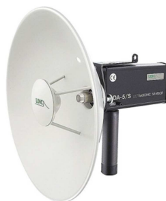
Abbildung 3-29: Ultraschallrichtmikrofon zur Teilentladung-Ortung [LDIC]
