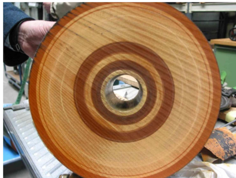
Abbildung 2-18: Schnitt durch einen RBP Wickelkörper mit ungleichmäßiger Öldurchtränkung [17]
