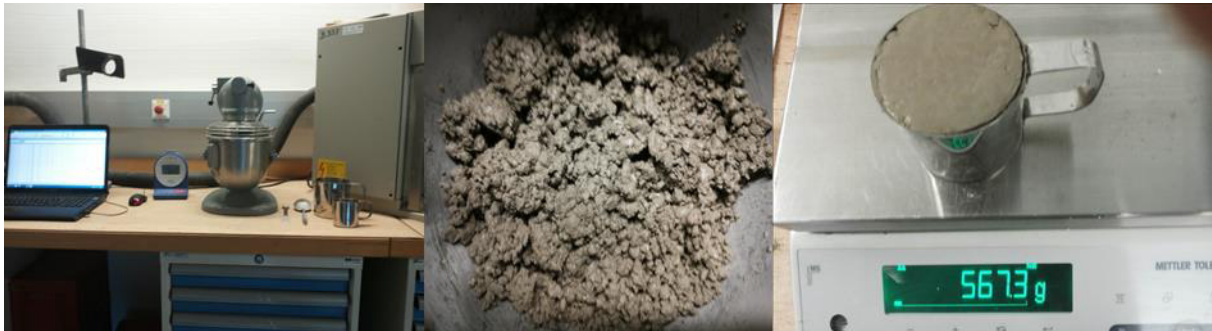
Abbildung 38: Vorgehensweise für einen Versuch nach dem Kwan-Verfahren für einen CEM II/A 42,5 R
