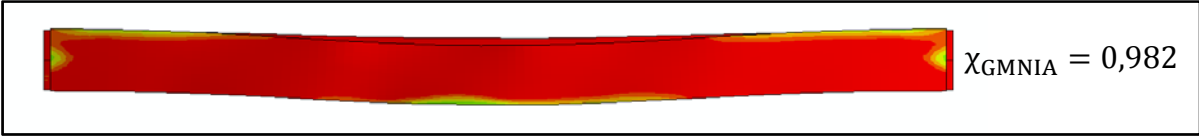
Fig. 37: LTB in case of k=0,5 k_w=0,5 \Psi=1 for HEB 300 section L=4,5 m
