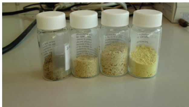
Abb. 4.15: Zunehmende Oxidation von mit 2-Methoxyethanol funktionalisierten SiNP
