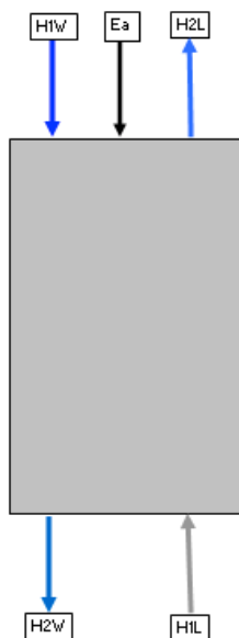
Abbildung 4-1 Energiebilanz am Kühlturm (Bilanzgrenzen am Kühlturm)
