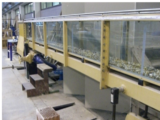
Abbildung 44: Sediment in der Versuchsrinne mit einem Durchmesser von 0,01 [m] 80
