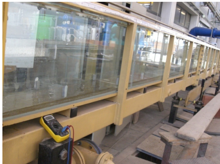
Abbildung 60: Sediment in der Versuchsrinne mit einem Durchmesser von 0,0015 [m] 96
