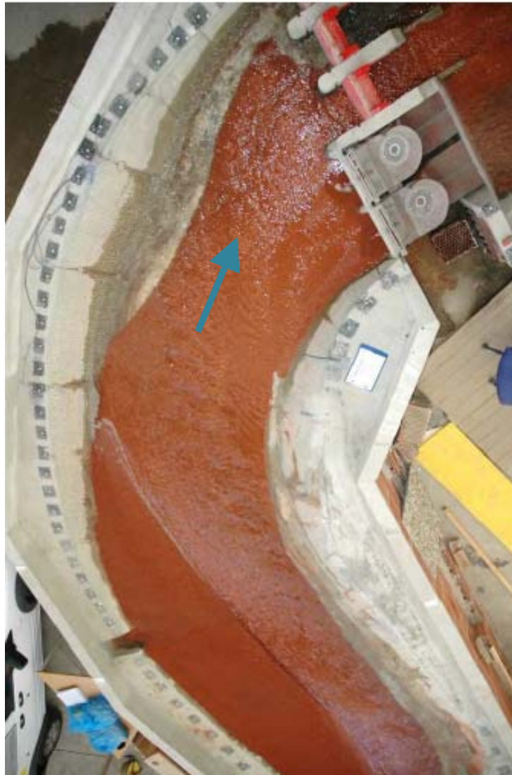
Abbildung 14: Einbau bewegliche Sohle 2002 aus Ziegelsplitt 23
