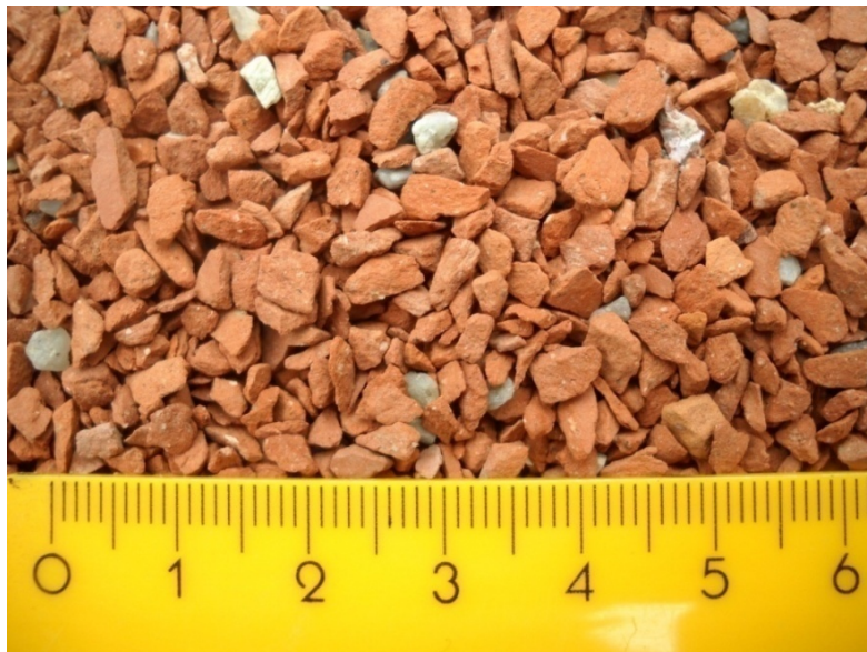
Abbildung 55: Sediment (Ziegelsplitt) mit einem Durchmesser von 0,003 [m] 91
