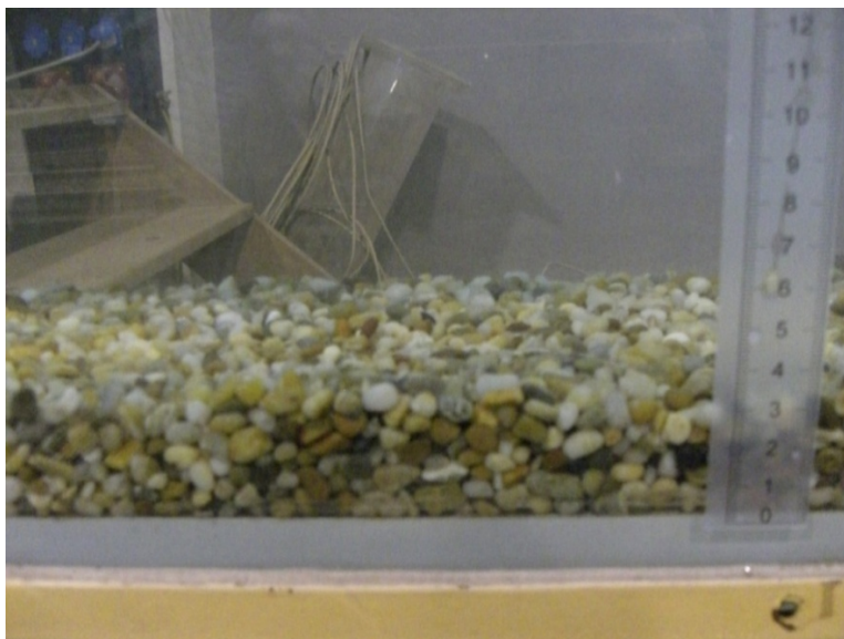
Abbildung 48: Sediment in der Versuchsrinne mit einem Durchmesser von 0,006 [m] 84
