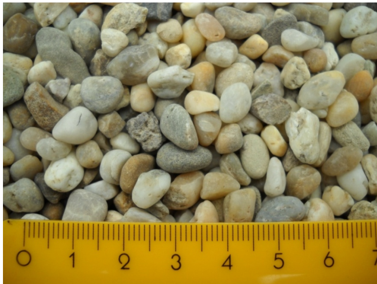
Abbildung 47: Sediment mit einem Durchmesser von 0,006 [m] 83
