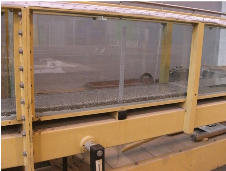
Abbildung 52: Sediment in der Versuchsrinne mit einem Durchmesser von 0,0035 [m] 88
