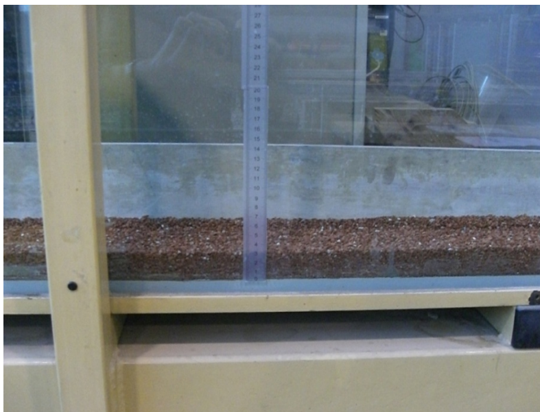
Abbildung 56: Sediment in der Versuchsrinne mit einem Durchmesser von 0,003 [m] 92
