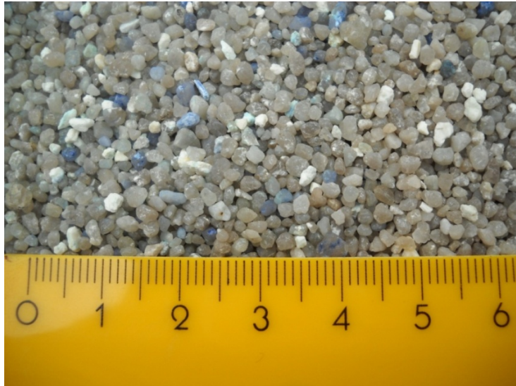
Abbildung 59: Sediment (Quarzsand) mit einem Durchmesser von 0,0015 [m] 95
