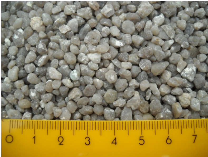
Abbildung 51: Sediment (Quarzsand) mit einem Durchmesser von 0,0035 [m] 87
