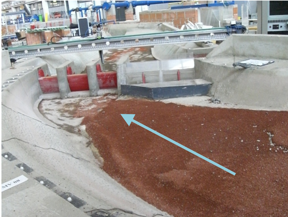
Abbildung 16: Kraftwerk Schönau Model (Variante Einlaufschwelle) 27
