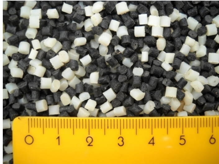
Abbildung 63: Sediment mit einem Durchmesser von 0,003 [m] 99
