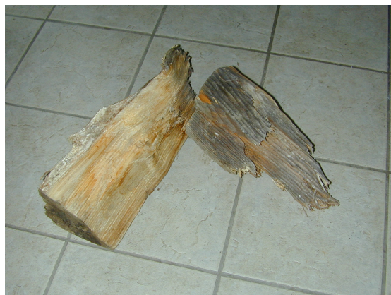
Abbildung 10: Typische Formabweichungen: Äste, Abweichungen von der Prismenform
