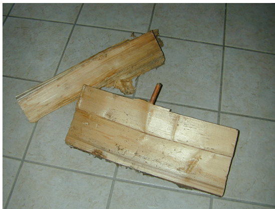
Abbildung 10: Typische Formabweichungen: Äste, Abweichungen von der Prismenform
