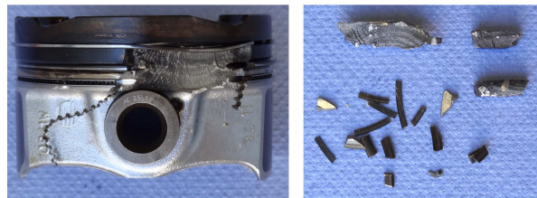
Abbildung 9.4: Kolbenschaden nach 80 Betriebsstunden
