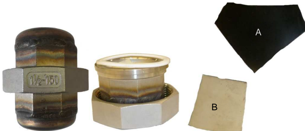
Abbildung 4-9: Foto des Prüfdruckbehälters und der untersuchten Membranen
