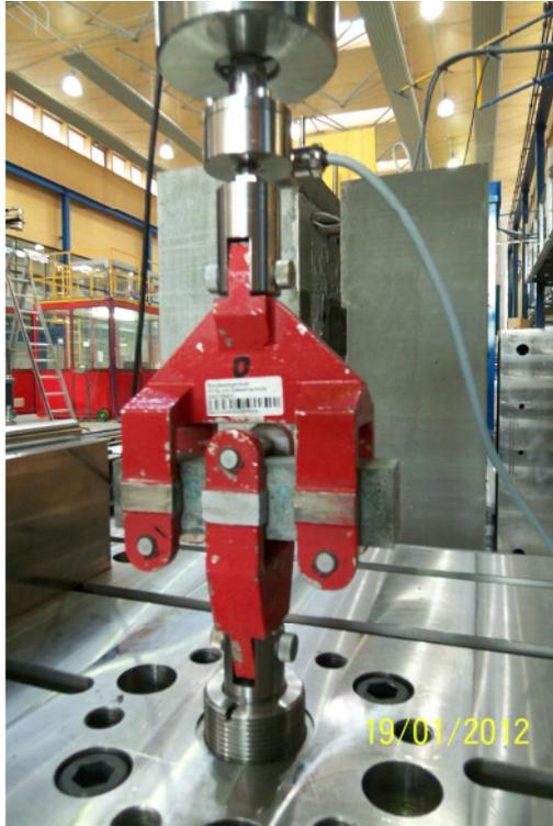
Abbildung 43 Durchführung der Biegezugversuche auf der Universalprüfmaschine BETA 1000
