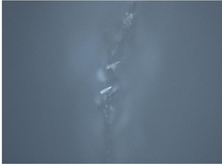
Abbildung 73 Abgebrochene Fasern - Blick in Richtung Bruchflächenebene
