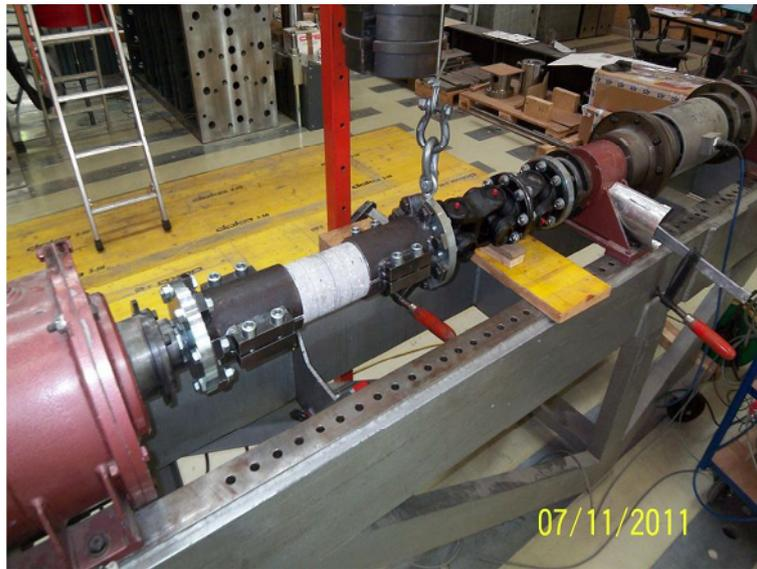
Abbildung 35 Torsionsdrehmaschine
