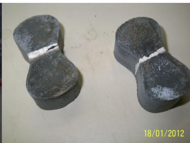
Abbildung 63 Hergestellte Prüfkörper für die Basaltfaserausziehversuche
