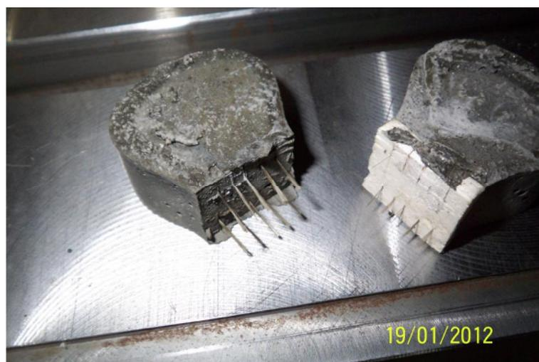
Abbildung 64 Hundeknochenform - ausgezogene Basaltrovings – 6 mm Einbindetiefe
