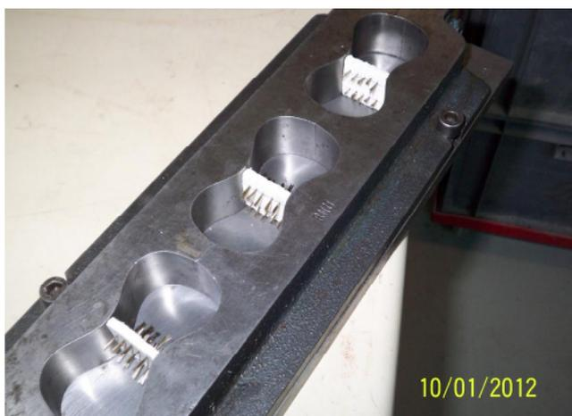
Abbildung 62 Prüfkörperherstellung für die Basaltfaserausziehversuche
