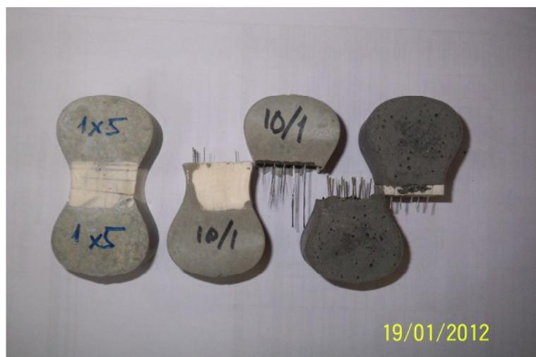
Abbildung 66 Prüfkörper vor bzw. nach Durchführung der Ausziehversuche
