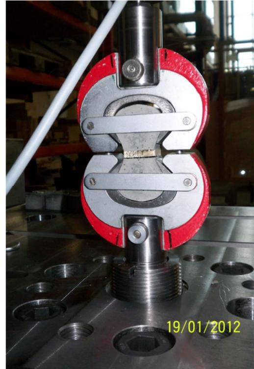
Abbildung 44 Durchführung der Faserausziehversuche auf der Universalprüfmaschine BETA 1000
