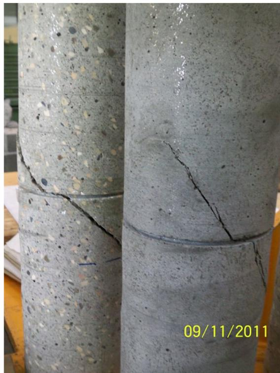
Abbildung 38 Verlauf der Bruchfläche bei 6 mm Kerbtiefe (CeraCem links und Ductal rechts)
