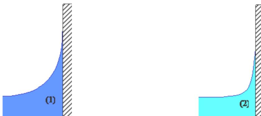
Abbildung 28 Flüssigkeiten mit größerer (1) und geringerer (2) Oberflächenspannung (17)
