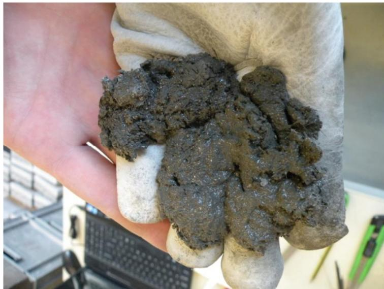
Abbildung 24 Frischbeton mit den aufgelösten Faserbündeln
