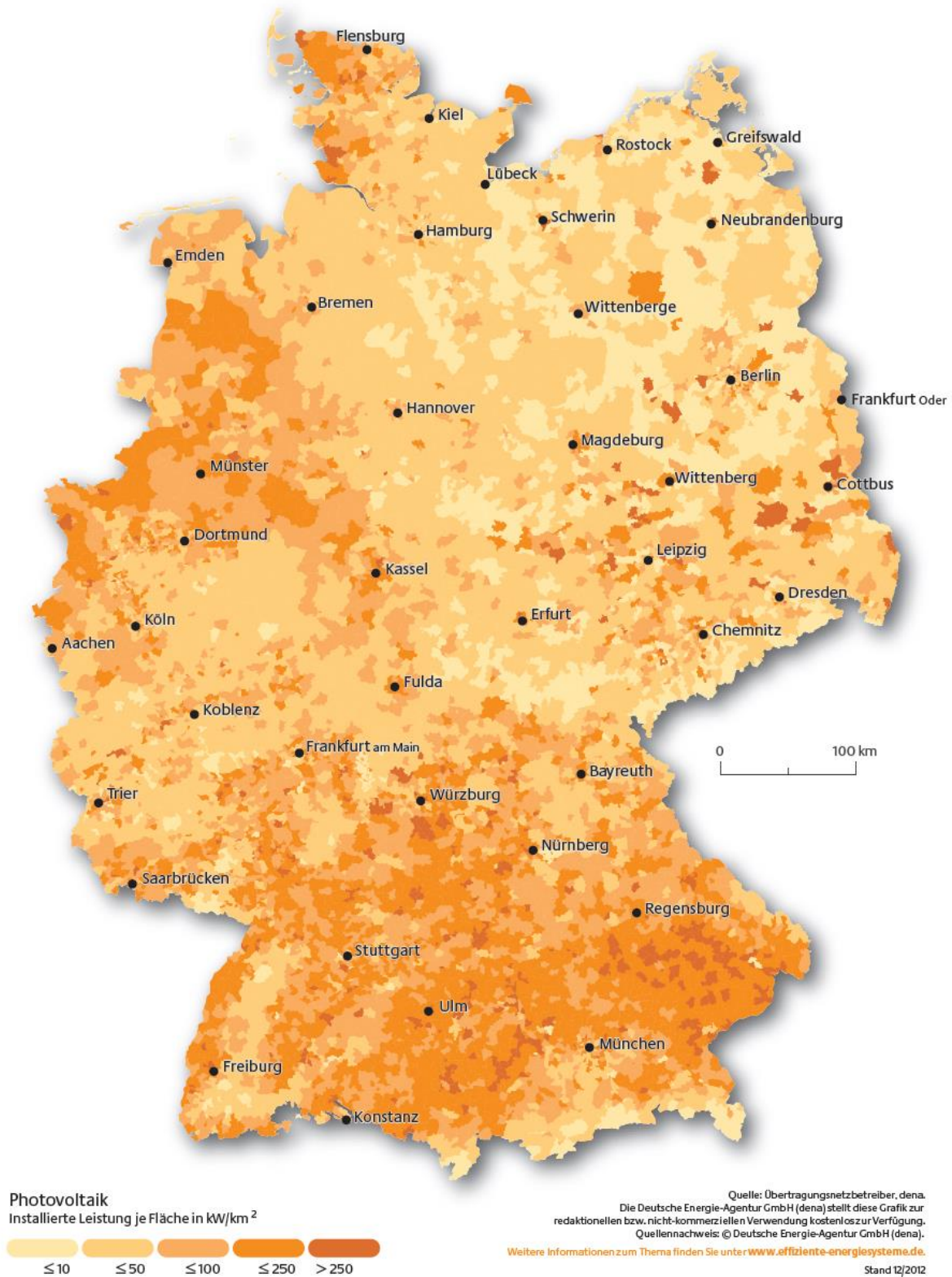
Abbildung 5.8: Installierte Photovoltaikleistung in Deutschland 12/2012
