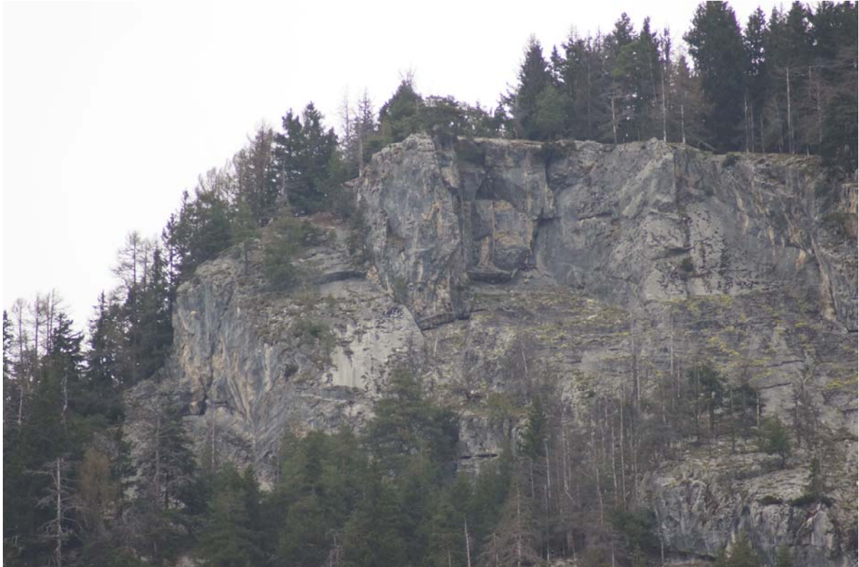
Foto 6: Durch Zoom in das Bild konnten hier viele Trennflächen im Bereich des Gipfels identifiziert werden, z.B. Set Green (Bankung) und Set Blue.
