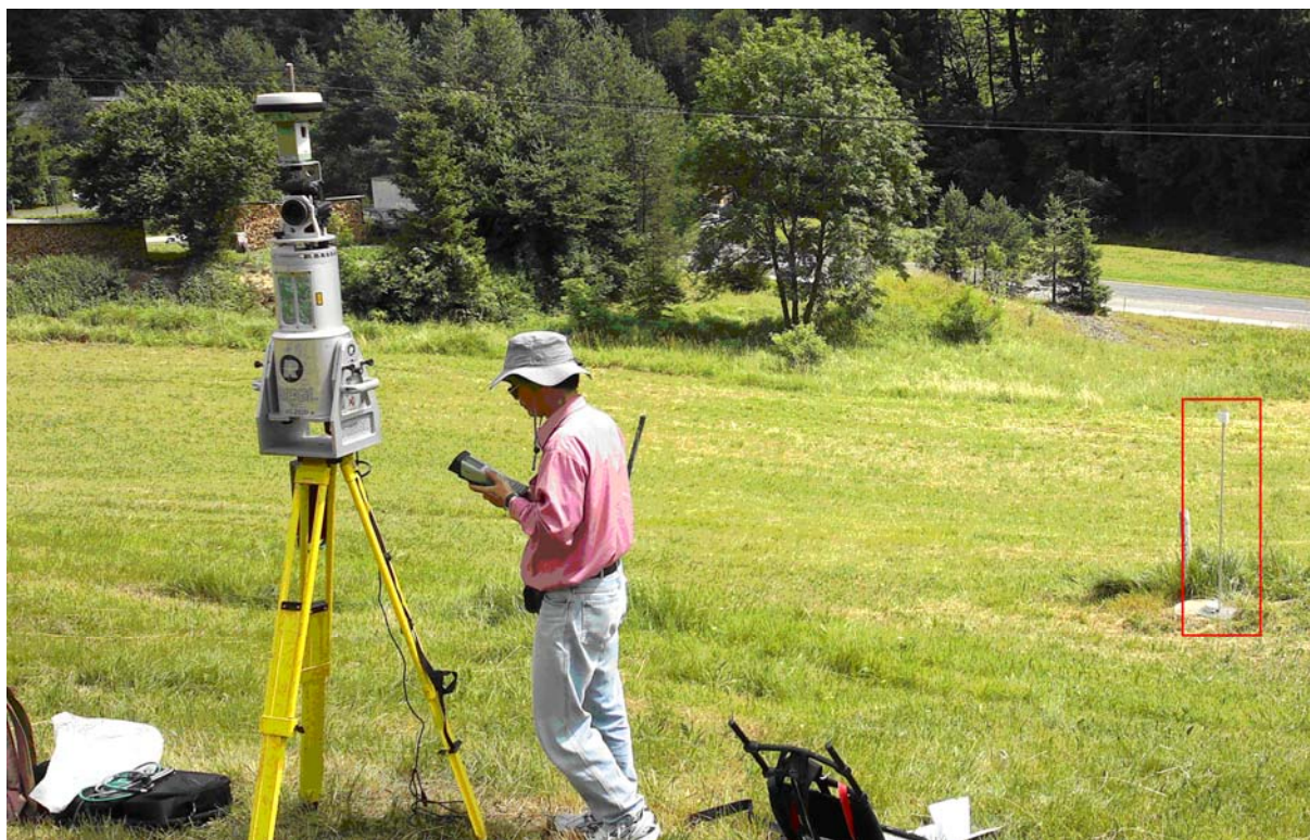
Abbildung 5: Scannersetup; Laserscanner, montierte Kamera und Laptop sind für den Scanvorgang notwendig. GPS Gerät wird temporär montiert. Rechts im Bild ist ein Reflektor zu sehen (Markierung)
