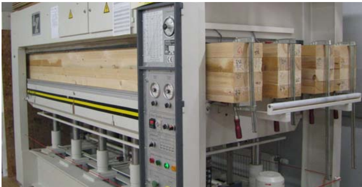
Abb. 2.19 Holzplattenpresse LangzaunerPresse LZT 160-SF, Verleimung der Gurte der Serie T-6
