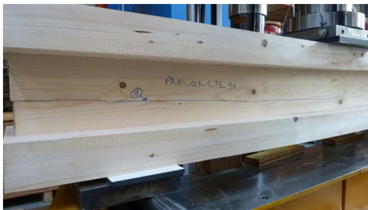
Abb. 2.52 Schubversagen im Steg Serie T5_36
