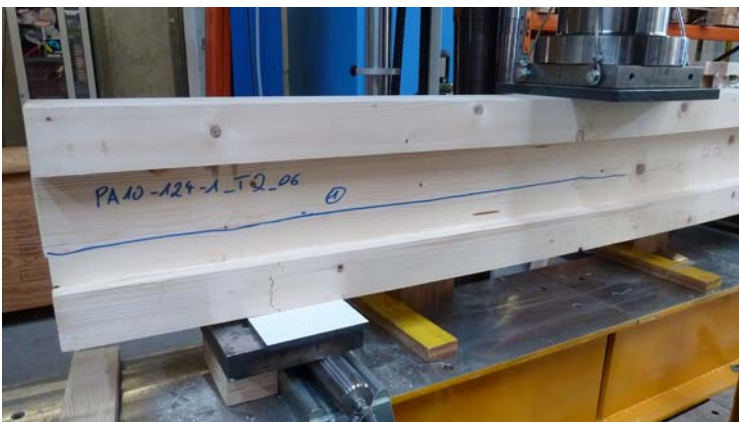
Abb. 2.46 Schubversagen im Steg Serie T2_06
