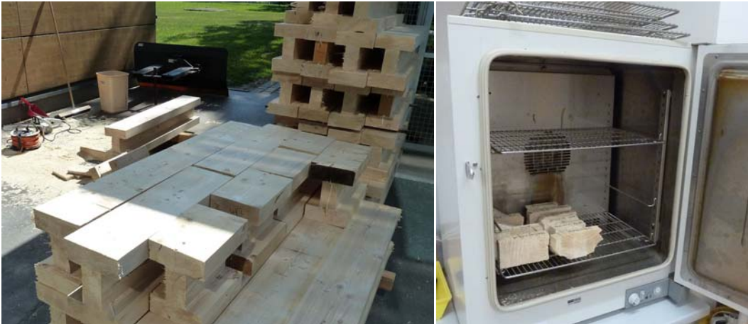
Abb. 2.42 Herstellung der Darrprobe (links); Umlufttrockenschrank mit Darrproben (rechts)
