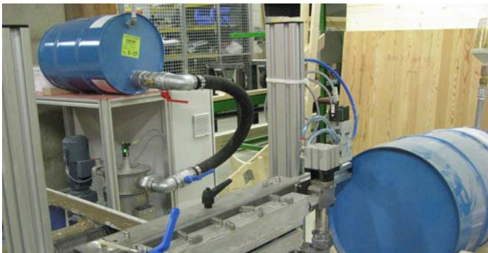
Abb. 2.32 Klebegasse des Lignum Test Centers des Institutes für Holzbau und Holztechnologie der TU Graz mit Einkomponenten-Polyurethan-Klebstoff
