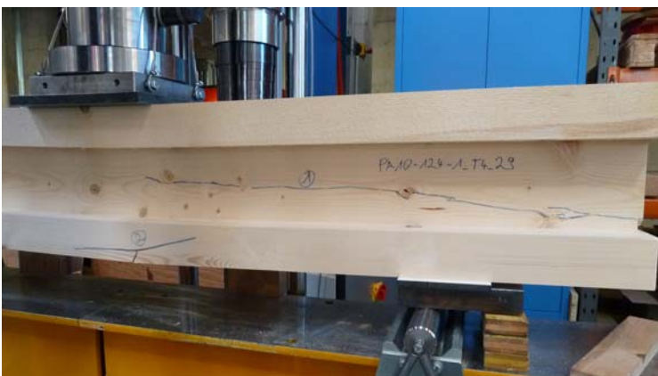
Abb. 2.50 Schubversagen im Steg Serie T4_29
