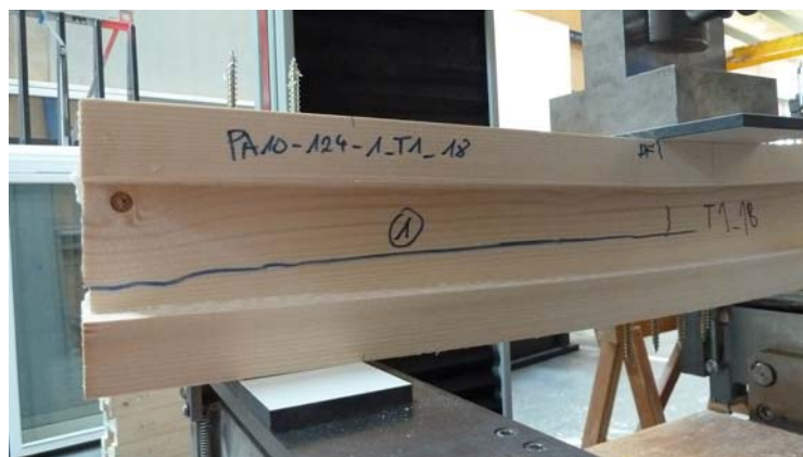
Abb. 2.44 Schubversagen im Steg Serie T1_18
