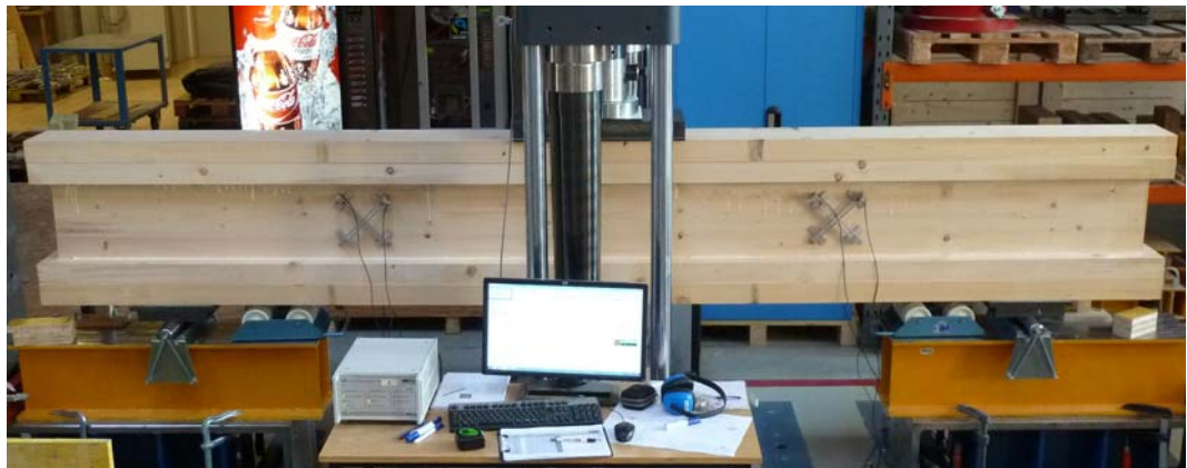
Abb. 2.54 Darstellung eines Prüfkörpers der Serie T-6 mit in den Schubfeldern angebrachten DD1-Wegaufnehmern
