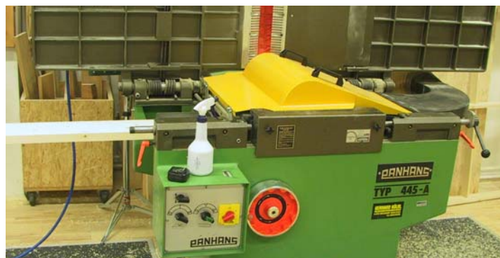
Abb. 2.18 Hobelmaschine Panhans 445-A
