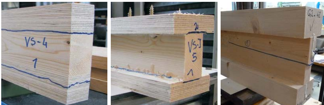
Abb. 2.1 Darstellung des Prüfquerschnitts bei den Vorversuchen nach Lackner [15] (links: Rechteck QS mit Kerto-S, mitte: I-QS mit Kerto-S) sowie der Träger der hier ausgeführten Prüfserie T-2 (rechts: I-QS aus Fichte S10+)
