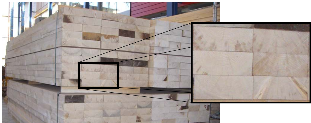
Abb. 2.2 Angeliefertes Ausgangsmaterial (Fichte, visuell sortiert, S10+, in Anlehnung an ON DIN 4074-1 [7])
