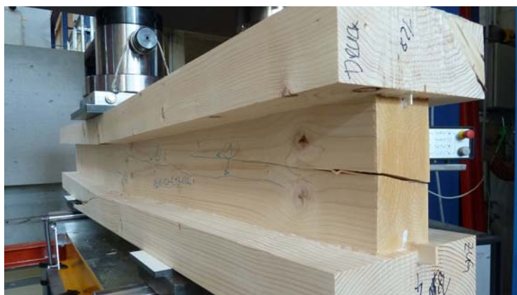
Abb. 2.48 Schubversagen im Steg Serie T3_02
