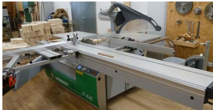
Abb. 2.17 Tischkreissäge Altendorf F45
