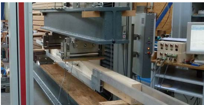
Abb. 2.29 Prüfgerüst für die 4-Punkt-Biegeprüfung laut ON EN 408 [5] an der Universalprüfmaschine ZWICK Z 275 des Lignum Test Centers des Institutes für Holzbau und Holztechnologie der TU Graz
