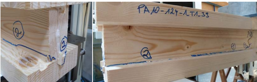
Abb. 3.2 Versagen des Trägers T1_39 auf Schub im Übergangsbereich S_UB
