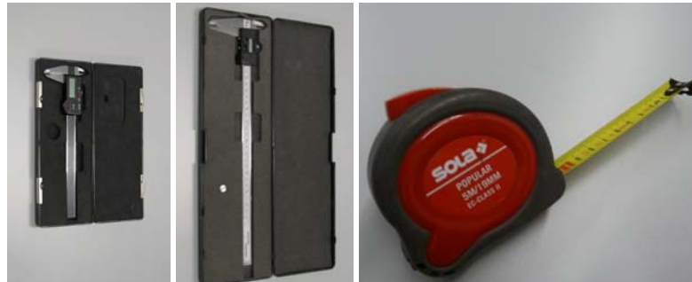
Abb. 2.26 Digitale Messschieber, Mitoya 16 EX 150 (links), Mitoya 16 EX 300 (mitte) und Rollmeter (rechts)
