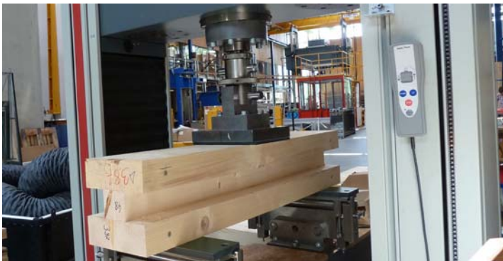
Abb. 2.28 Universalprüfmaschine ZWICK Z 250 des Lignum Test Centers des Institutes für Holzbau und Holztechnologie der TU Graz.
