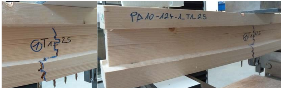
Abb. 3.4 Versagen des Trägers T1_25 auf Biegezug im Untergurt B_UG
