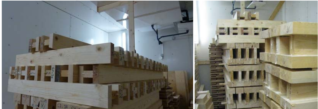
Abb. 2.37 Konditionierung der Prüfträger in der Klimakammer
