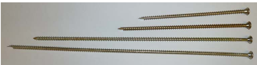
Abb. 2.33 Verwendete Vollgewindesenkkopfschrauben \varnothing 8 mm, der Firma Schmid, Star Drive [41] (1. von oben 8x200, 2. von oben 8x240 und 4. von oben 8x460) und der Firma SPAX, SPAX ® -S [42] (3. von oben 8x400)
