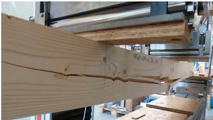
Abb. 2.58 Biegeversagen im Bereich des maximalen Momentes; Serie T8_12
