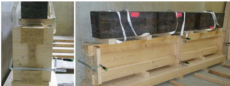
Abb. 2.36 Schablonen zum Einrichten (links) sowie Verklebung der Serie T-6 (rechts)
