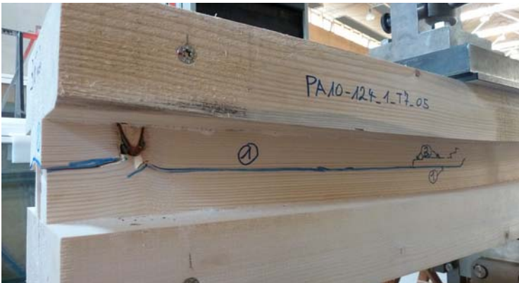
Abb. 2.57 Schubversagen im Steg Serie T7_05
