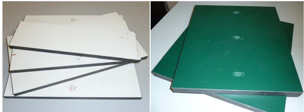
Abb. 2.34 Hochdruck-Schichtstoffplatten der Firma FunderMax [43], Max Compact Platten (links), Max Alucompact42 Platten (rechts)
