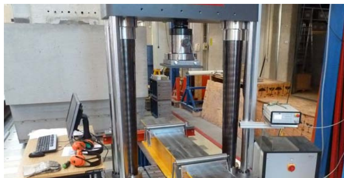
Abb. 2.27 Universalprüfmaschine BETA_1000 des LKI der TU Graz
