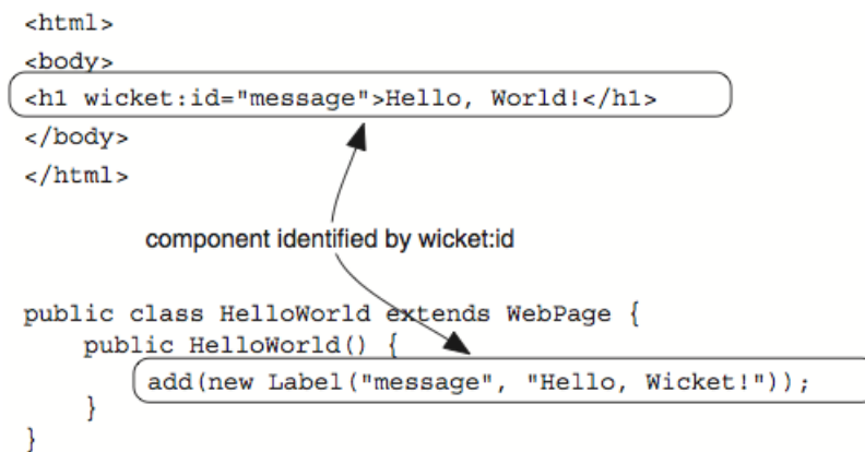
Abbildung 6.5: Zusammenhang zwischen XHTML-Template und Java Komponenten [Dashorst und Hillenius, 2008]
