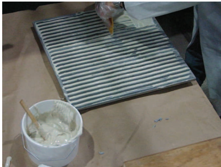
Abbildung 3.10: Aufbringung des Klebstoffs im Labor [1]
