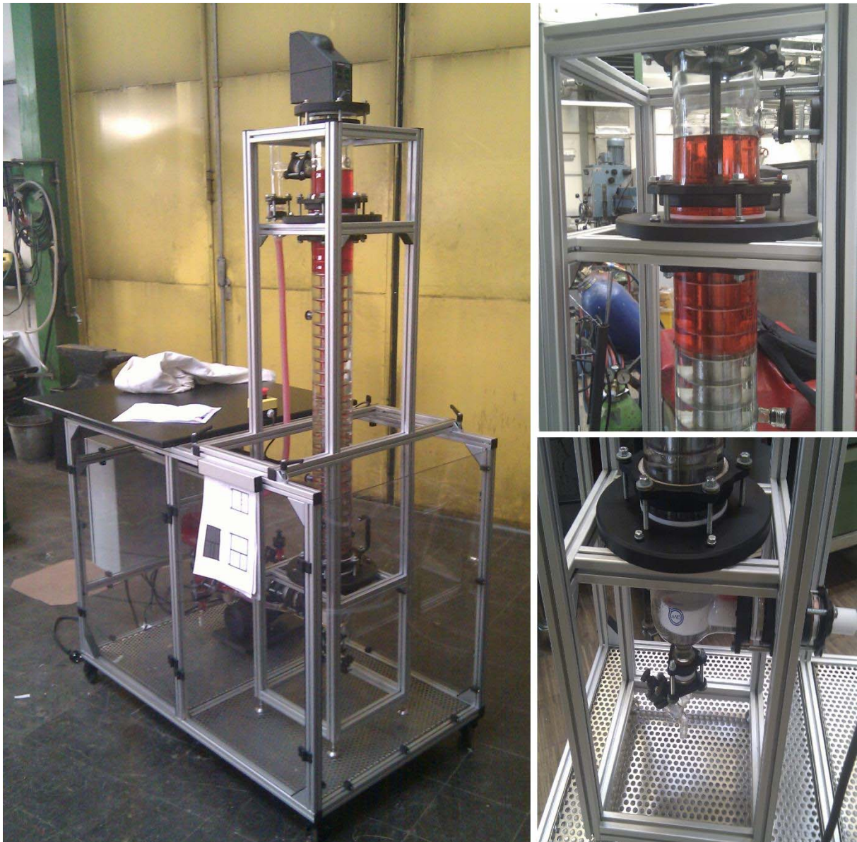
Abbildung 3-7: Mobile Laborkolonnen mit Detailaufnahmen.
