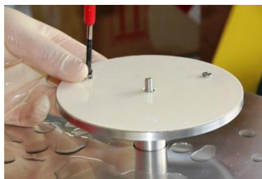
Abbildung 5-30: Befestigen des festen Isolierstoffes
