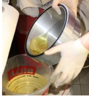
Abbildung 5-33: Spülen des Gefäßes mit aufbereiteter Isolierflüssigkeit
