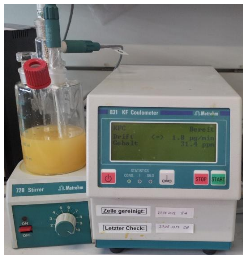
Abbildung 5-39: 831 KF Coulometer zur Bestimmung des Feuchtegehaltes Isolierflüssigkeiten
