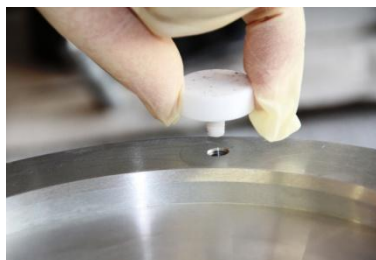
Abbildung 5-22: Montieren der Teflonstützen in den Gefäßboden
