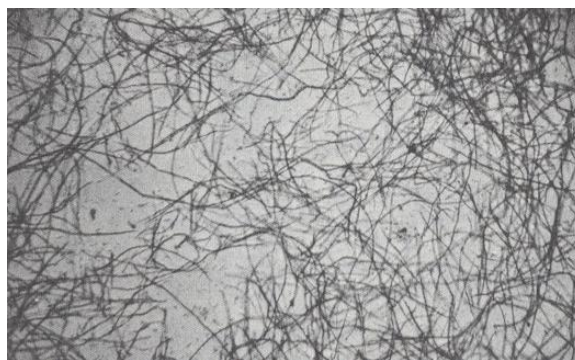
Abbildung 2-13: Zellulose-Fasern nach der Verarbeitung in den Kegelmühlen [Mos79:24]
