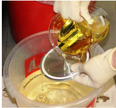
Abbildung 5-29: Spülen der Aluminiumscheibe mit aufbereiteter Isolierflüssigkeit
