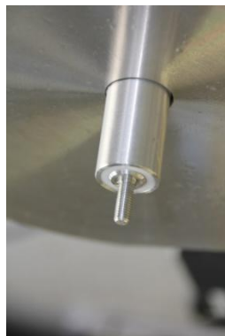
Abbildung 5-28: Isolation der Welle
