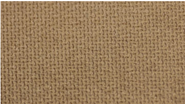
Abbildung 2-14: Transformerboard B 3.1A
