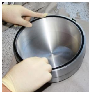
Abbildung 5-26: O-Ring in die Fuge drücken
