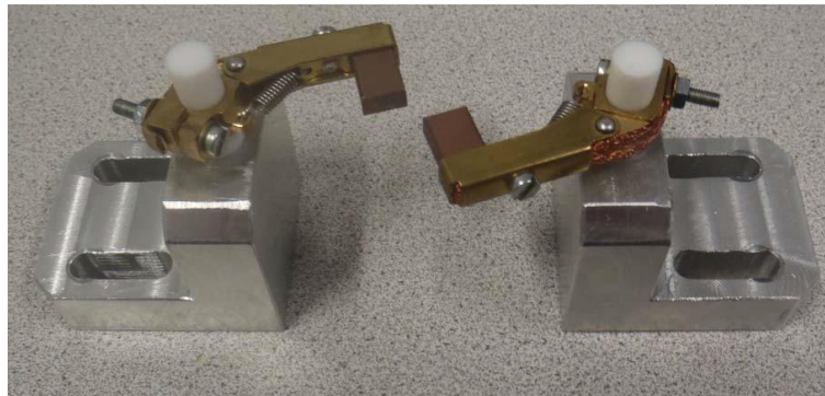
Abbildung 5-6: Kohlebürsten zur Stromabnahme an der Welle [Zlo:44]
