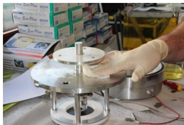
Abbildung 5-32: Deckel mit einem fusselfreien Tuch und der Isolierflüssigkeit abwischen
