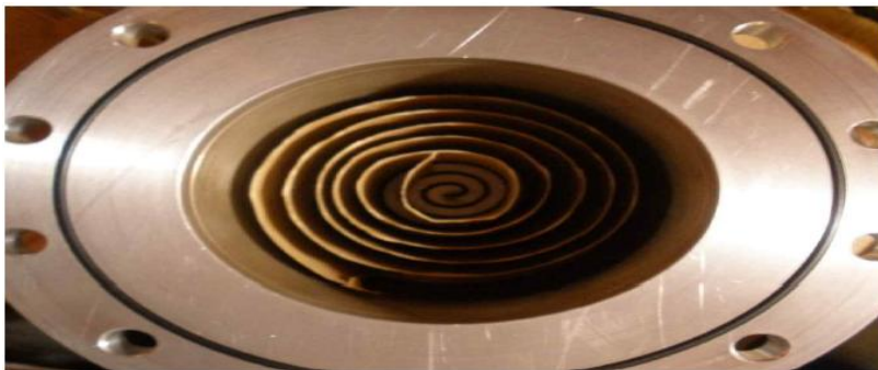
Abbildung 4-47: Spiralförmige Anordnung des Isolierpapierees in Versuchsbehälter 2 [Cho11: 2]
