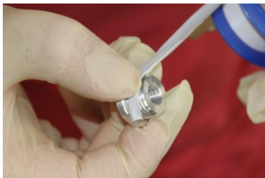
Abbildung 5-23: Teflonband auf das Gewinde des Zwischenstückes aufbringen
