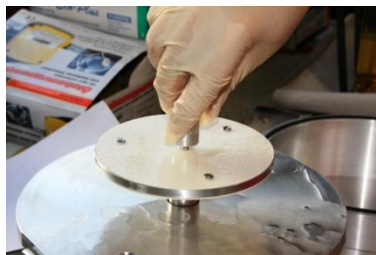
Abbildung 5-31: Aluminium-PTFE Endstück an die Welle schrauben
