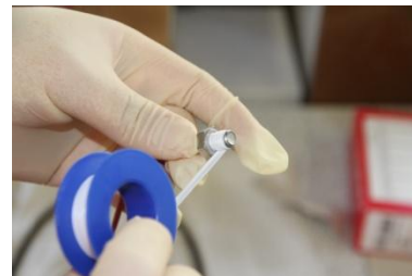
Abbildung 5-24: Teflonband auf den Temperatursensors aufbringen
