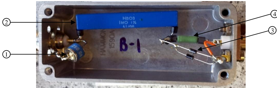
Abbildung 5-10: Fotografische Aufnahme der Schutzbeschaltung: Funkenstrecke (1), 1 MΩ Widerstand (2), gegen- gleich parallel geschaltete Dioden (3), 100 Ω Widerstand (4)
