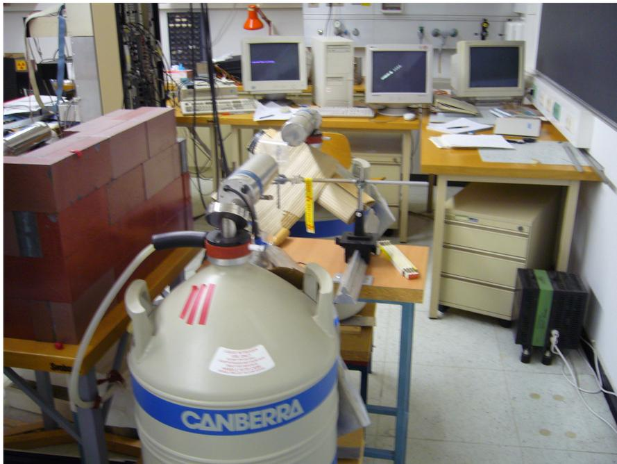
Abbildung 15: Messanordnung der 2-dimensionalen Dopplerverbreiterung
