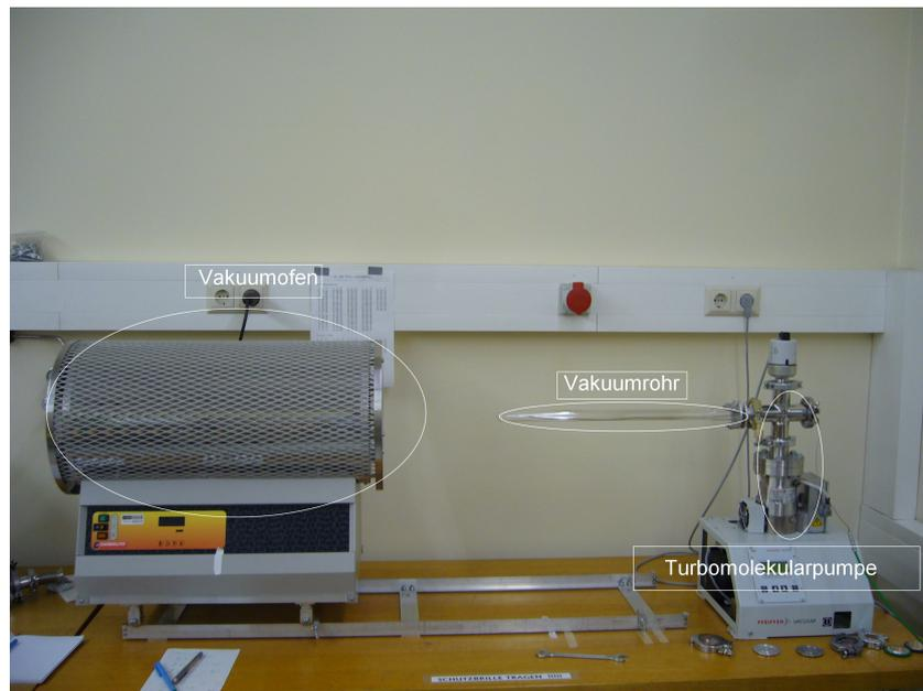
**Abbildung 25:** Der für die Temperaturbehandlung benutzte Rohrofen(1), sowie der Pumpstand (2) besteht aus einer Vorvakuumpumpe und einer Turbomolekularpumpe. Ebenso zu sehen ist das Vakuumrohr aus Quarzglas mit dem darin befindlichen Ni-CrNi Thermoelement zur Temperaturmessung.
