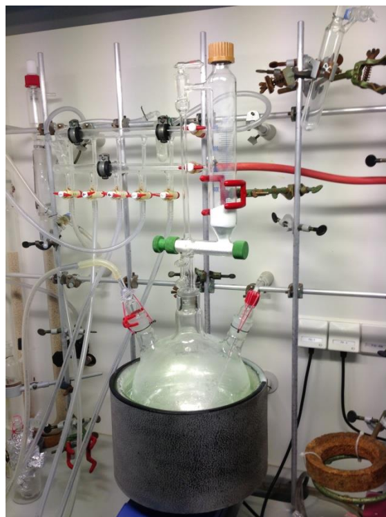
Abbildung 44: Aufbau zwecks Chlorierung inkl. Pulverschnecke
